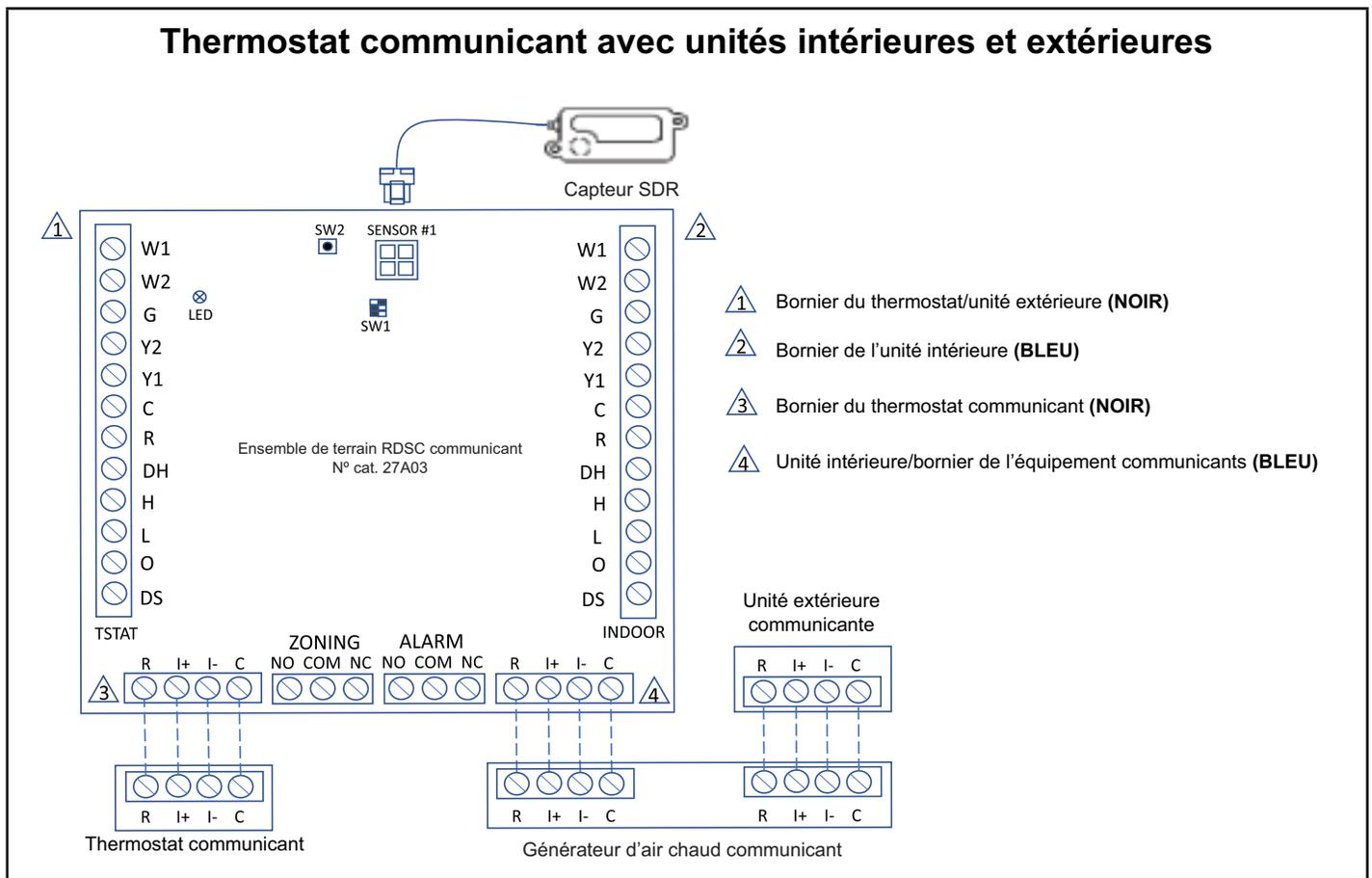
FIGURE 12. EL22KCV avec thermostat communicant S40 - Schéma de câblage sur place avec contrôleur du SDR
