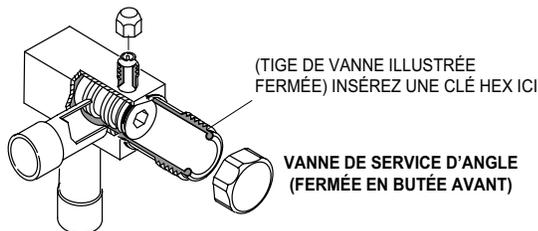
Lorsque la vanne de service est **FERMÉE**, l'orifice de service est ouvert sur le jeu de conduites et l'unité intérieure.
