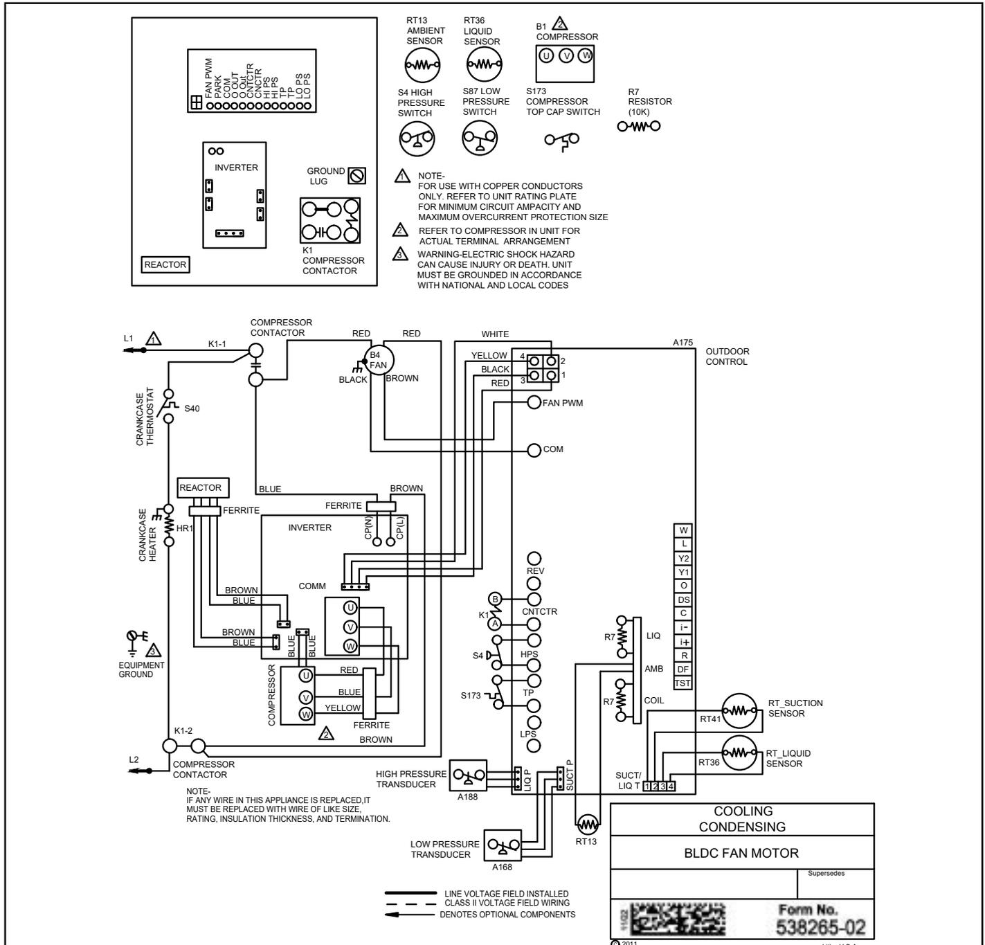
FIGURE 10. Câblage sur place typique
