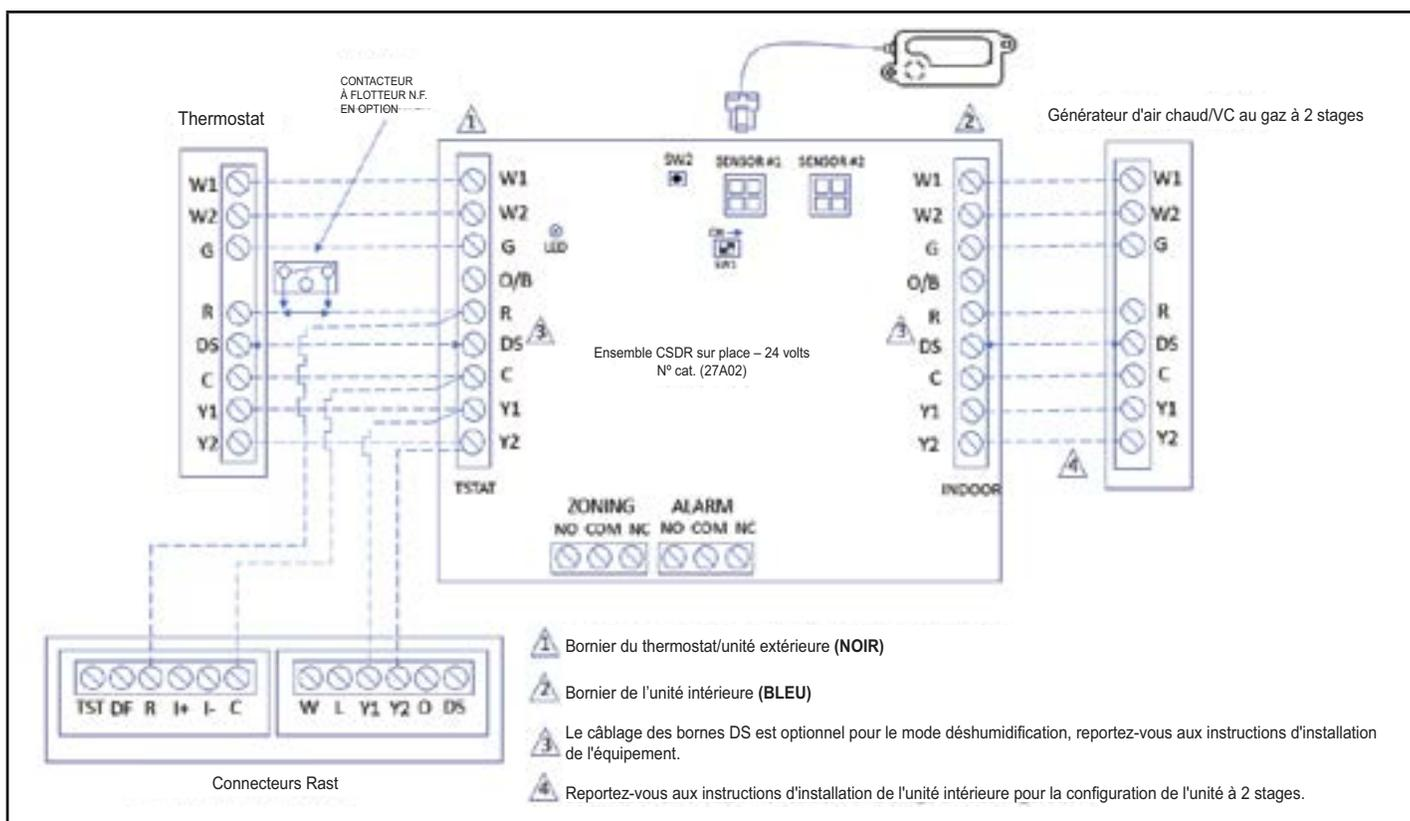
FIGURE 13. Câblage de thermostat de climatisation conventionnel 24 VCA non communicant avec contrôleur du SDR
