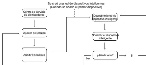
Figura 4. Creación de la red de dispositivos inteligentes y agregado de dispositivos inteligentes usando la aplicación Técnico inteligente de Lennox
