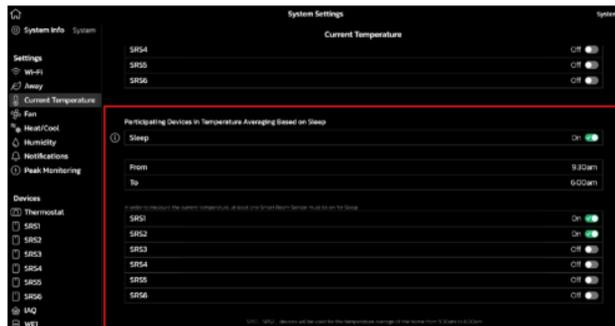
Figura 14. Termostato - Selecciones del Modo de sueño
