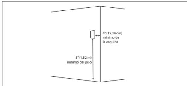
3. Use la plantilla de pared proporcionada junto con la herramienta de nivelación proporcionada en el sitio para una alineación horizontal apropiada en la pared antes de marcar los agujeros de montaje.
