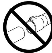
NE PAS ÉCRASER LA CONNEXION DE LA VANNE DE SERVICE SI LE TUBE EST PLUS PETIT QUE LA CONNEXION
