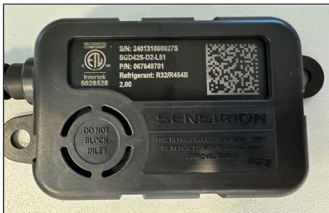
**FIGURA 22. Ejemplo de entrada del sensor libre y sin obstrucciones**
