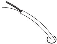
Étanchéifiez le trou dans le mur pour éviter que l'air chaud ou froid n'affecte le capteur de température de l'écran HD.
