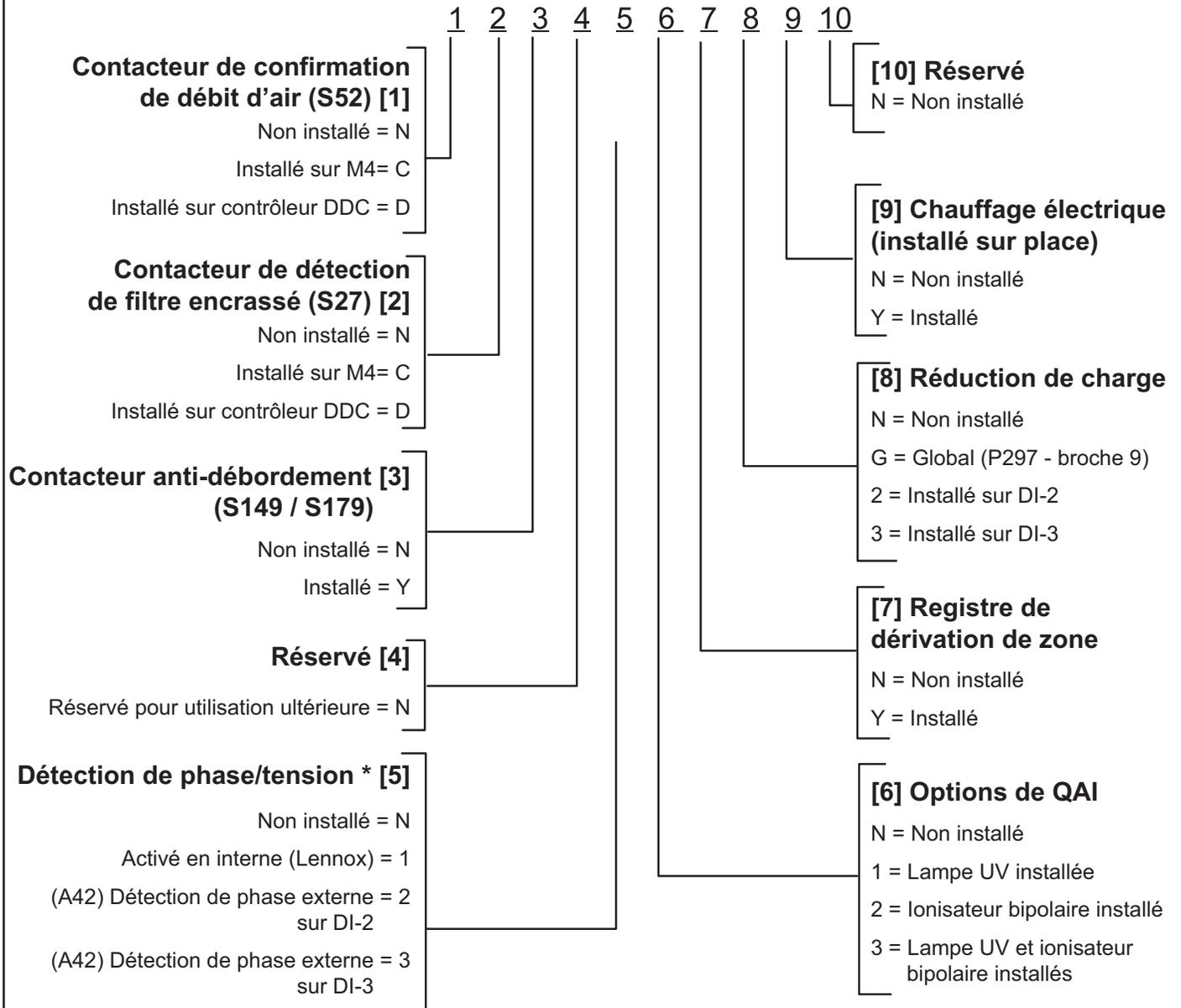
\* Si la détection de phase et la surveillance de la tension sont activées et incorrectement câblées, le système passe en mode de maintien de la demande et redémarre au bout de six minutes.
