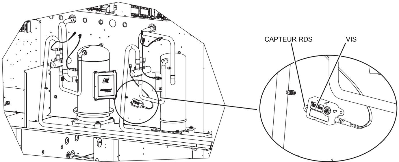
UTILISER DES SERRE-FILS POUR MAINTENIR LES FILS DU FAISCEAU
