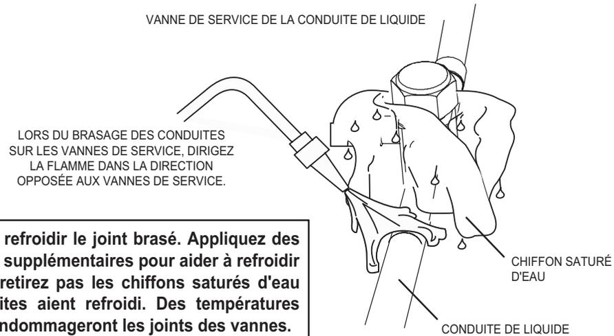
**IMPORTANT — Laissez refroidir le joint brasé. Appliquez des chiffons saturés d'eau supplémentaires pour aider à refroidir les joints brasés. Ne retirez pas les chiffons saturés d'eau avant que les conduites aient refroidi. Des températures supérieures à 250 °F endommageront les joints des vannes.**
