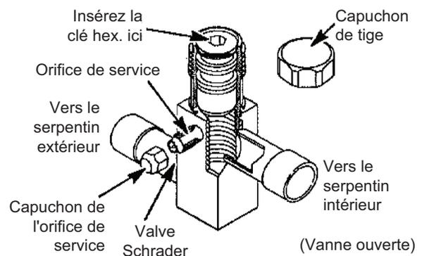
**FIGURE 14. Fonctionnement de la vanne de service d'angle**
