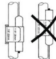
**REMARQUE - Confirmez le bon contact thermique entre la conduite de vapeur et le bulbe du clapet d'expansion avant d'isoler thermiquement le bulbe.**
