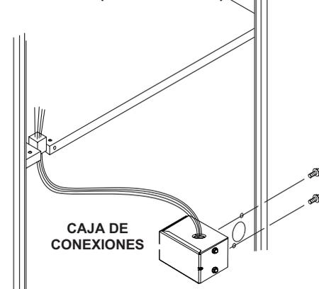
Corte los dos lazos prensacables para extender los cables eléctricos del lado derecho únicamente
