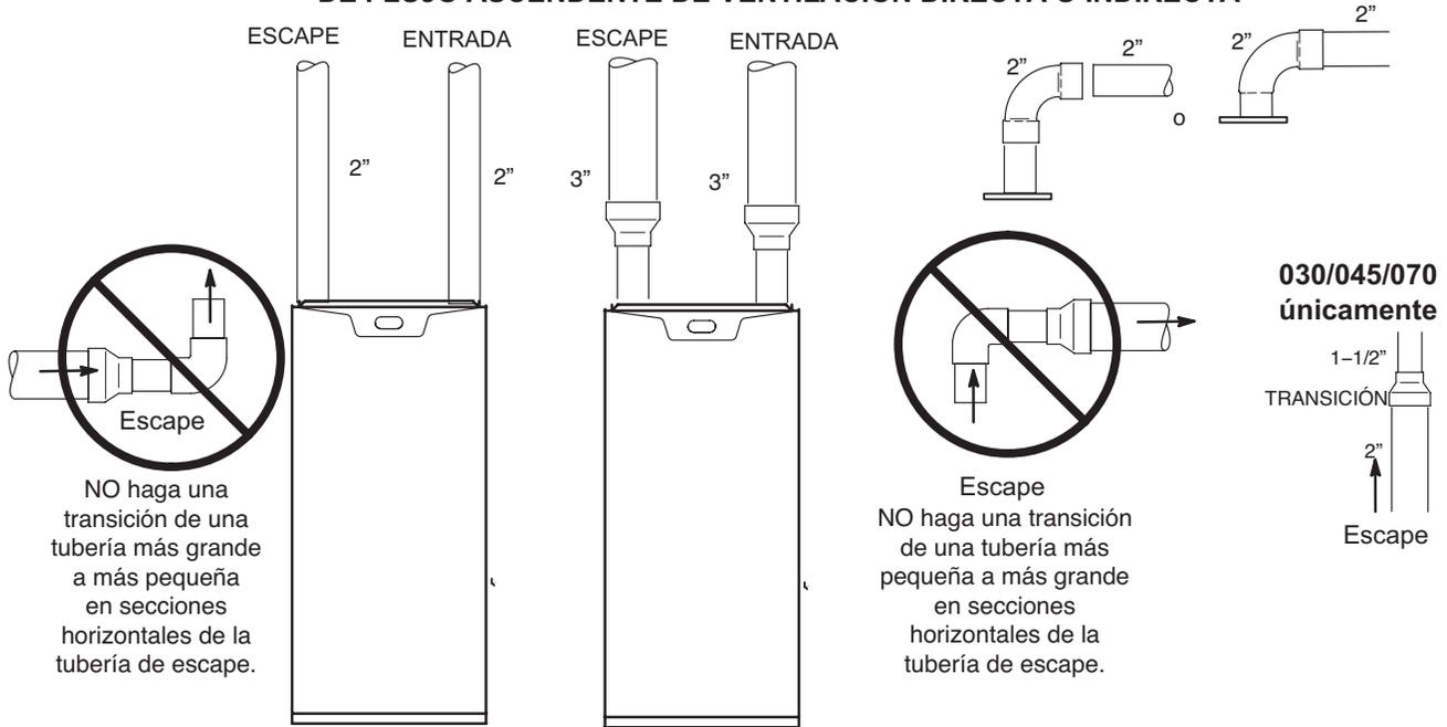
\* Durante la transición de aumento de tamaño de la tubería, use la sección más corta posible de tubería de PVC de 2".
