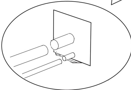
**F** COLOQUE UN TRAPO MOJADO CONTRA LA PLACA DE LAS TUBERÍAS Y ALREDEDOR DE LA CONEXIÓN DE LA LÍNEA DE SUCCIÓN.
