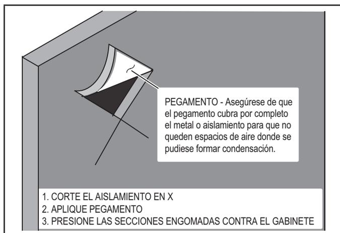
**FIGURA 19. Reparación del aislamiento**
