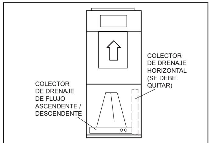
FIGURA 5. Configuración de flujo ascendente
