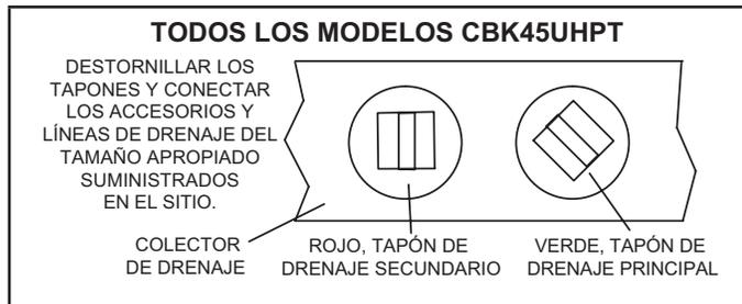
**FIGURA 12. Conexiones de las líneas de drenaje**
