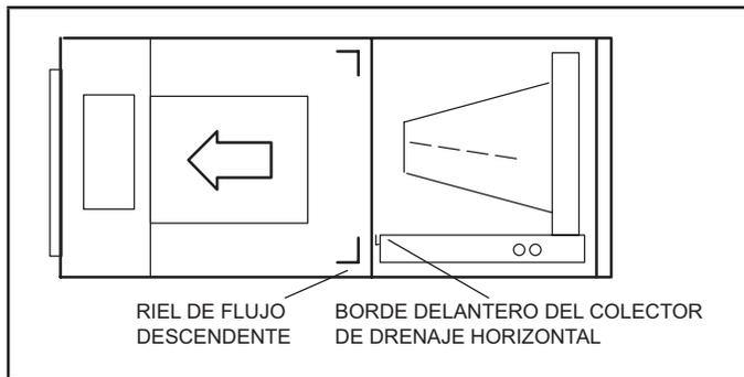
**FIGURA 9. Configuración de descarga a la izquierda**
