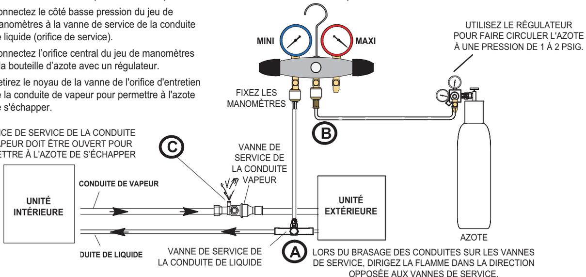
LORS DU BRASAGE DES CONDUITES SUR LES VANNES DE SERVICE, DIRIGEZ LA FLAMME DANS LA DIRECTION OPPOSÉE AUX VANNES DE SERVICE.
