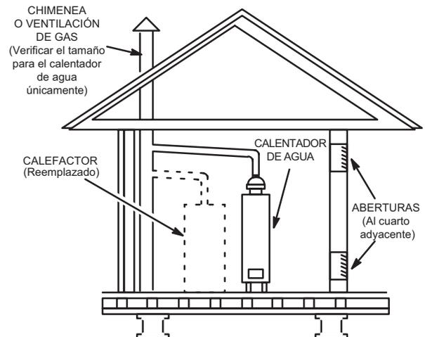
Si se reemplaza un calefactor que tenía una ventilación común con otro artefacto a gas, debe revisarse el tamaño de la tubería de ventilación existente para ese artefacto a gas. Sin el calor de los productos de la combustión del calefactor original, es probable que la tubería de ventilación existente esté sobredimensionada para el único calefactor de agua u otro artefacto. La ventilación se debe revisar para verificar el consumo apropiado con el artefacto restante.
