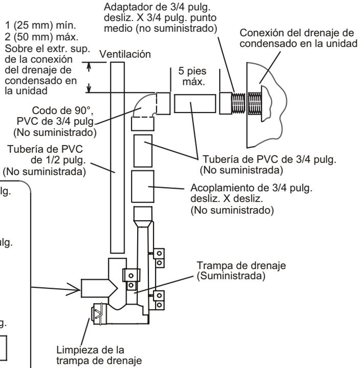
Ensamble de trampa de condensado con tubería de 1/2 pulg.
