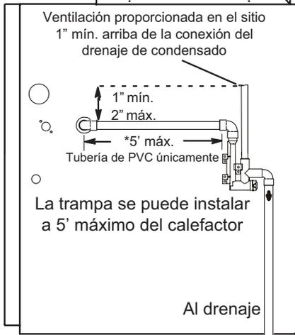
\*Desde el calefactor, la trampa se debe inclinar hacia abajo un mínimo de 1/4" por pie hacia la trampa
