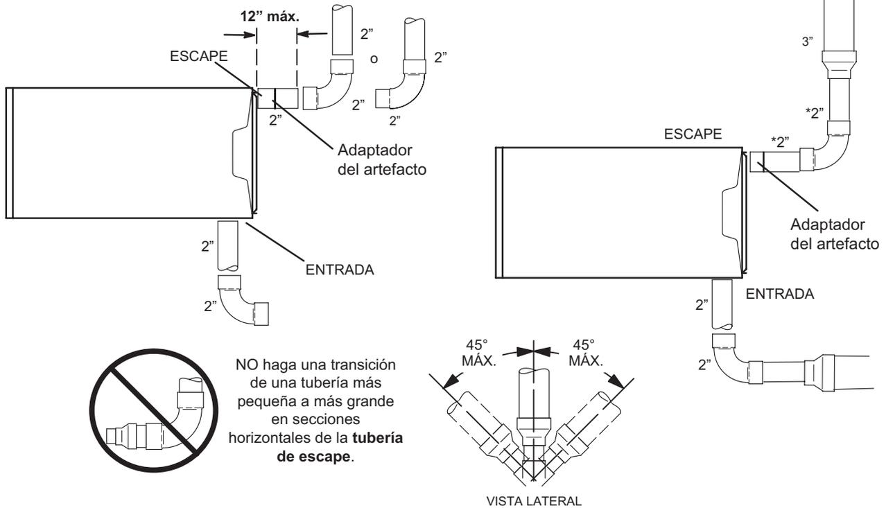
NO haga una transición de una tubería más pequeña a más grande en secciones horizontales de la tubería de escape.
