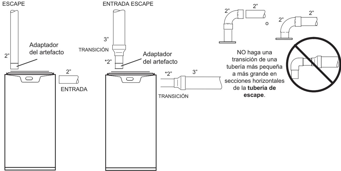
\* Durante la transición de aumento de tamaño de la tubería, use la sección más pequeña posible de tubería de PVC de 2".
