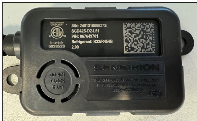
FIGURA 22. Ejemplo de entrada del sensor libre y sin obstrucciones
