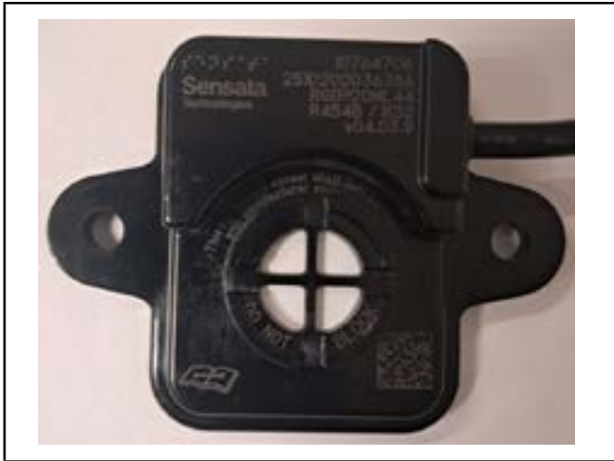
FIGURA 30. Ejemplo de entrada del sensor libre y sin obstrucciones
