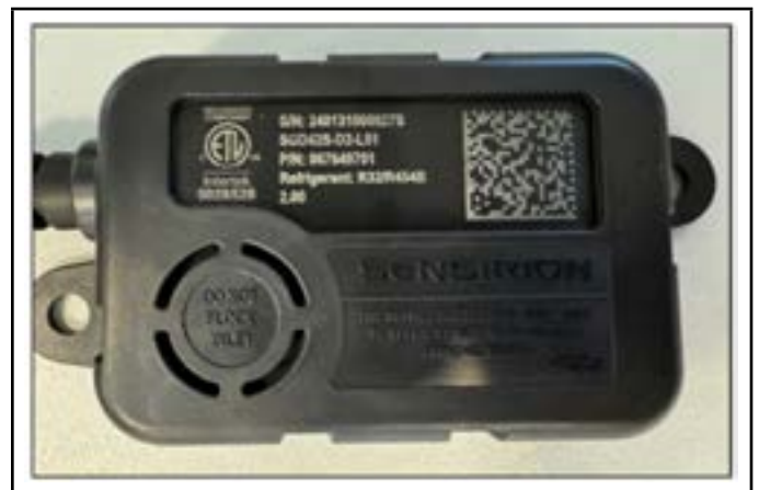
FIGURA 29. Ejemplo de entrada del sensor libre y sin obstrucciones
