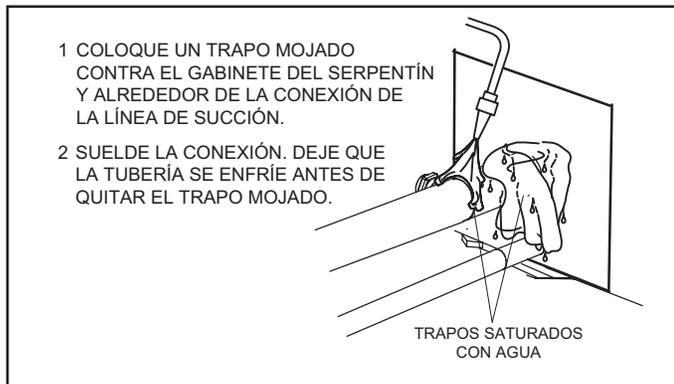
**FIGURA 2. Soldadura de las líneas de refrigerante**
