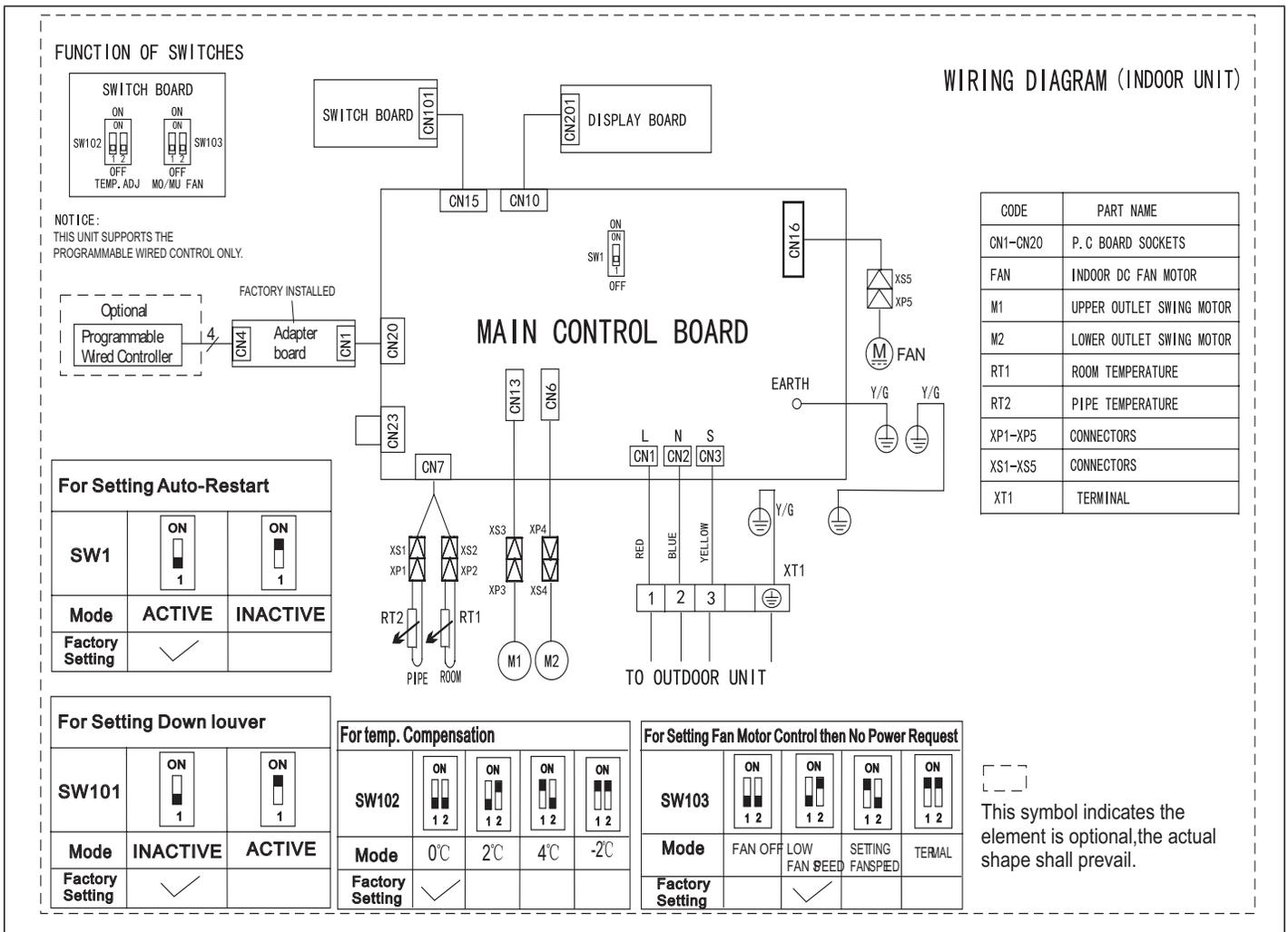
**Figure 24. MFMA012S4-\*P Unit Wiring Diagram**
