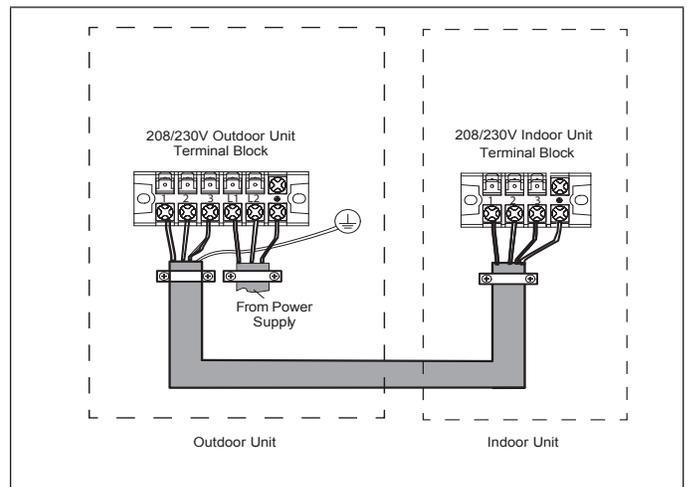
**Figure 23. Single-Zone Wiring 12K**
