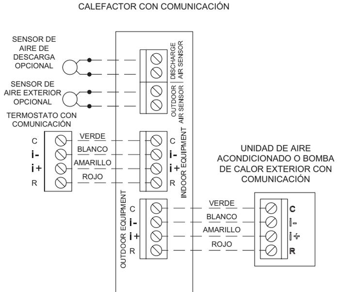
Los sistemas de comunicación utilizan cuatro alambres entre el termostato y el control del calefactor/unidad de manejo de aire y cuatro alambres entre la unidad exterior y el control del calefactor/unidad de manejo de aire. Cuando se usa un cable de termostato con más de cuatro alambres, los alambres extra se deben conectar correctamente para evitar el ruido eléctrico. Los alambres no se deben dejar desconectados.
