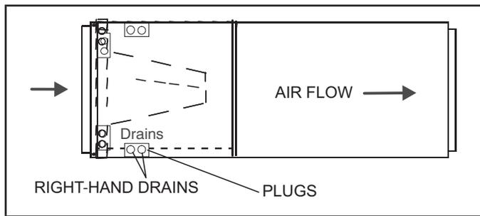
**FIGURE 15. Right-Hand Discharge Configuration**
