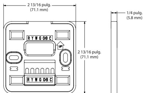
Figura 1. Termostato, cubierta y placa posterior del Lennox L40
