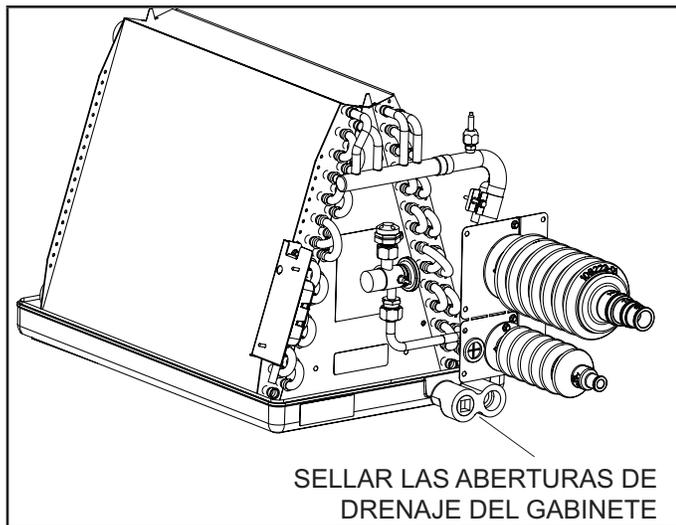
FIGURA 8. Unidad CK40UT con manguitos de acople
