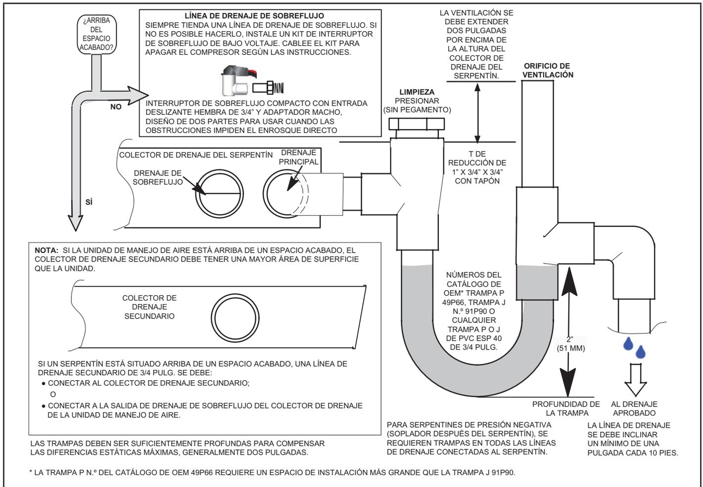
**FIGURA 9. Instalaciones típicas de drenaje principal y de sobreflujo**
