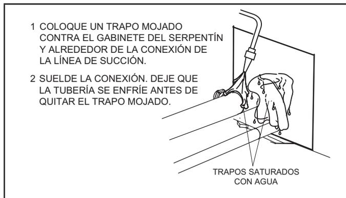
FIGURA 3. Soldadura de las líneas de refrigerante
