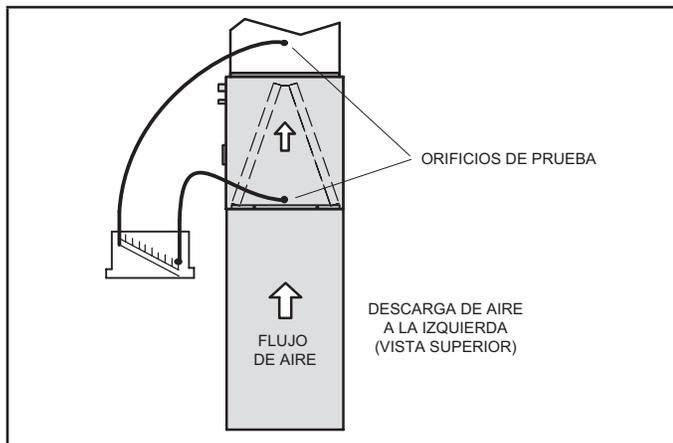
**FIGURA 10. Prueba de presión estática**
