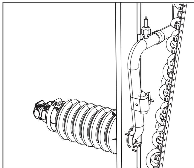
FIGURA 5. Línea de succión de 49C-60C con manguito de acople para la unidad CK40UT
