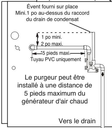
\*Le tuyau sortant de l'appareil doit avoir une pente minimum de 1/4 po par pied vers le purgeur
