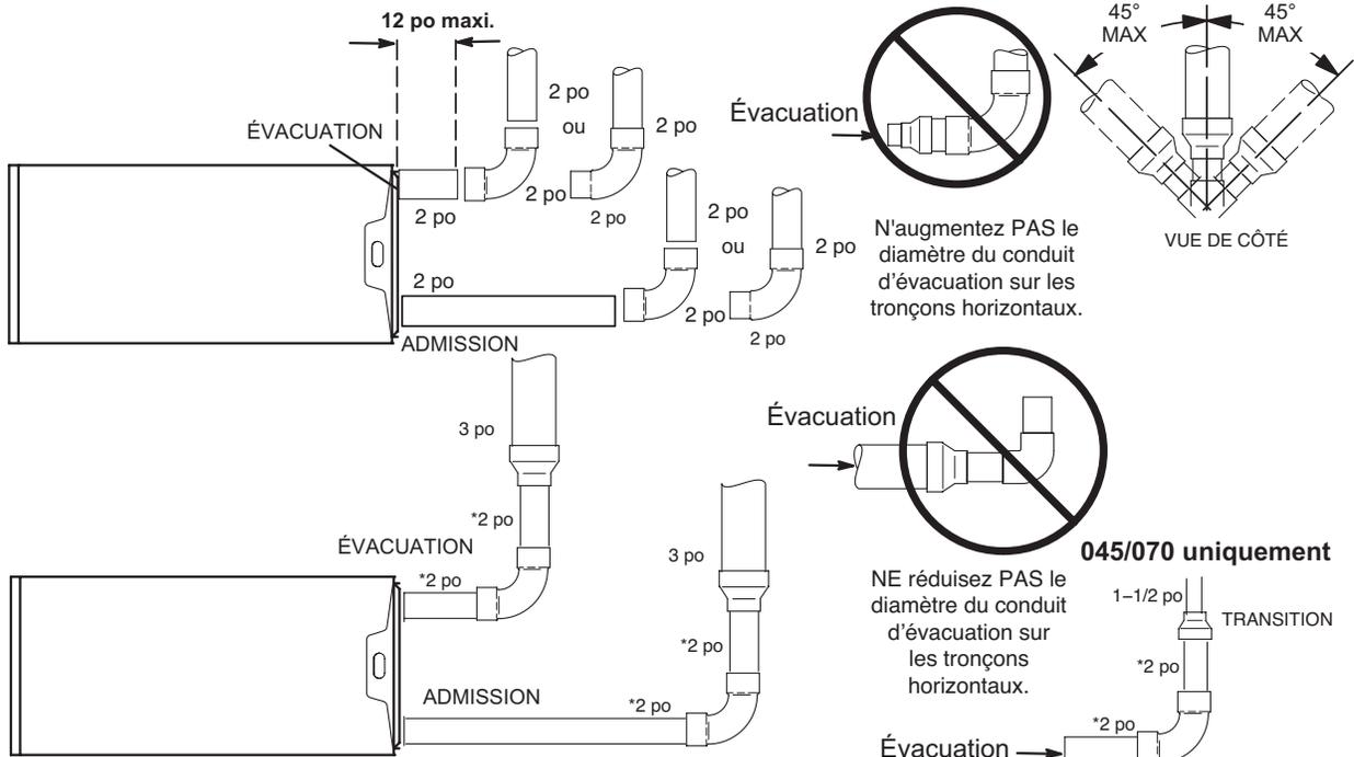
\* Pour passer à un tuyau de plus grand diamètre, utilisez la longueur de tuyau en PVC de 2 po la plus courte possible.
