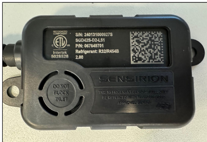
FIGURA 21. Ejemplo de entrada del sensor libre y sin obstrucciones
