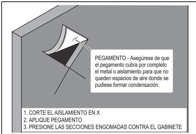
FIGURA 22. Reparación del aislamiento
