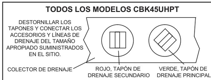
**FIGURA 15. Conexiones de las líneas de drenaje**
