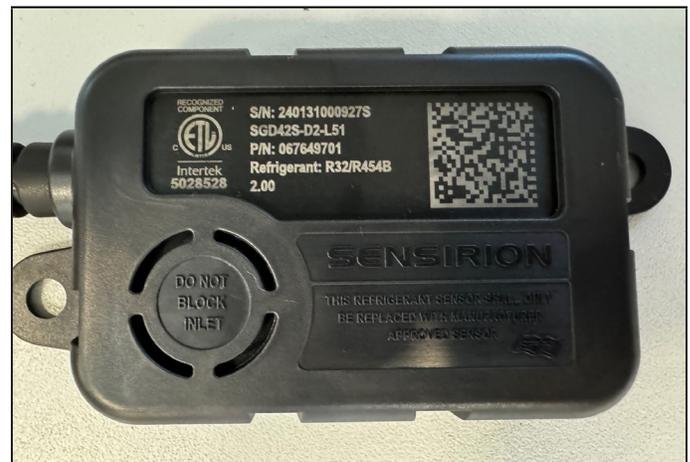
FIGURA 23. Ejemplo de entrada del sensor libre y sin obstrucciones
