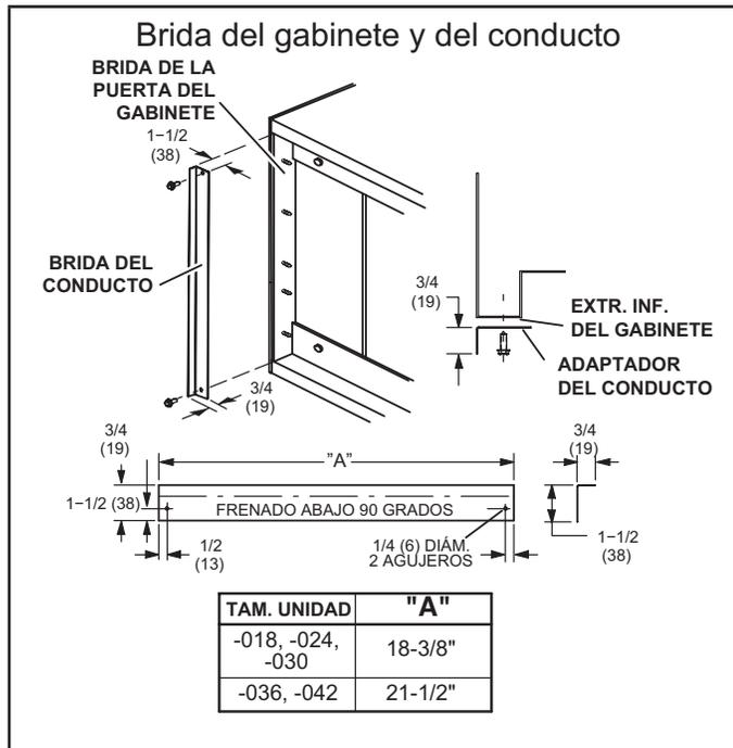
FIGURA 16. Brida del gabinete y del conducto
