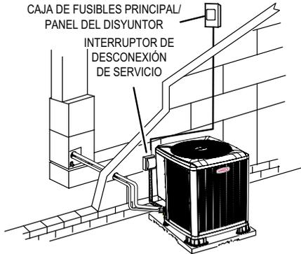
**NOTA** - Las unidades se aprueban para usarse con conductores de cobre únicamente. Conecte a tierra la unidad en el interruptor de desconexión o conéctela a una tierra sólida.
