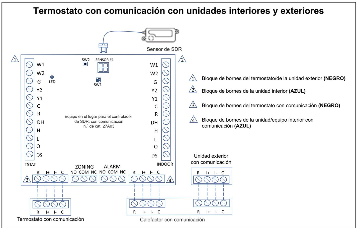
**FIGURA 12. Diagrama de cableado en el sitio con controlador SDR para el sistema EL22KCV con termostato S40 con comunicación.**
