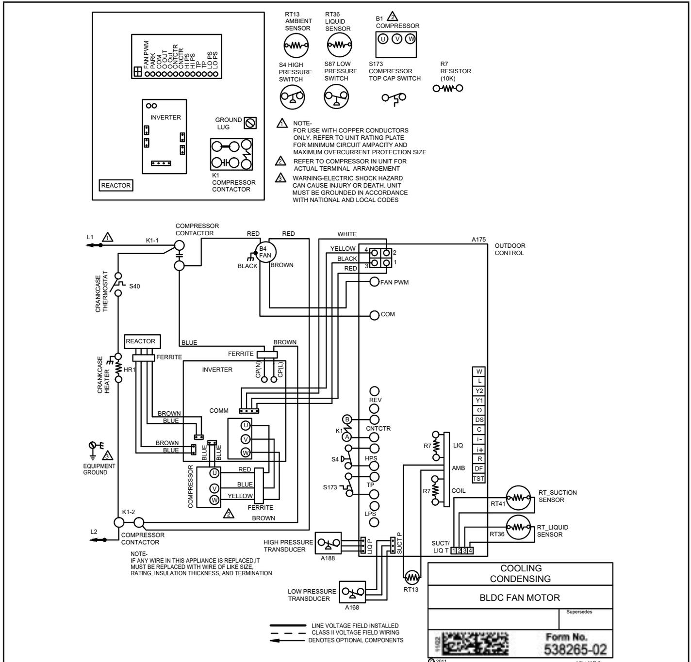
FIGURA 10. Cableado típico en el sitio
