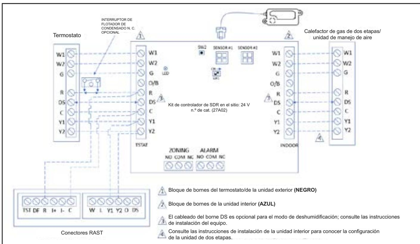
FIGURA 13. Cableado del termostato convencional de enfriamiento de 24 VCA sin comunicación con controlador SDR
