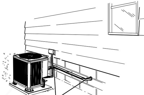
DOS CODOS DE 90° INSTALADOS EN EL CONJUNTO DE LÍNEAS REDUCIRÁN LA VIBRACIÓN DEL CONJUNTO.
