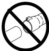
N'ÉCRASEZ PAS LA CONNEXION DE LA VANNE DE SERVICE SI LE TUBE EST PLUS PETIT QUE LA CONNEXION
