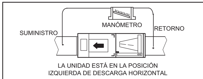
FIGURA 3. Prueba de presión estática
