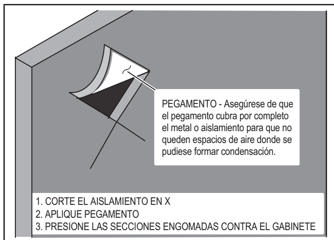
FIGURA 14. Reparación del aislamiento
