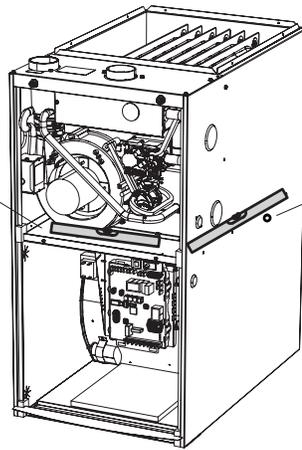
Coloque el nivel sobre los tornillos de la cubierta del soplador para chequear la inclinación hacia adelante
