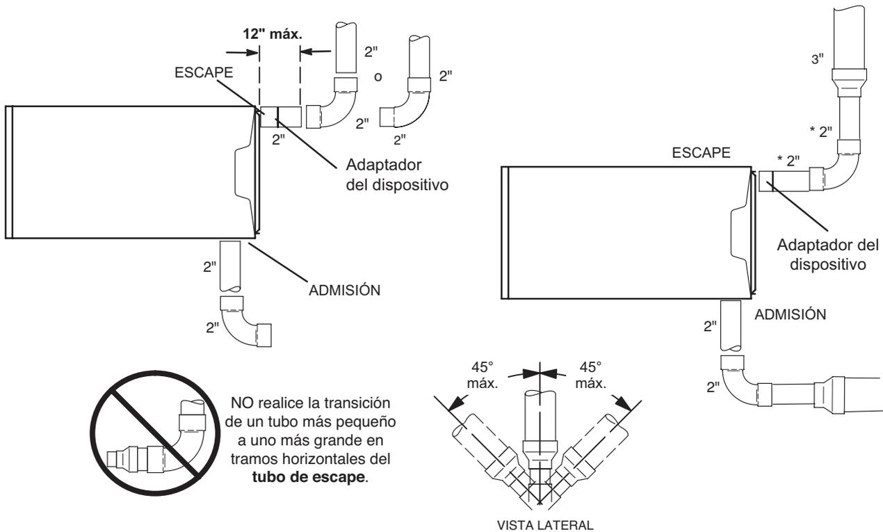
\* Al hacer la transición en el tamaño de la tubería, use la longitud más corta posible de tubería de PVC de 2".
