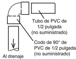
Conjunto de drenaje para la tubería de drenaje de 3/4 de pulgada
