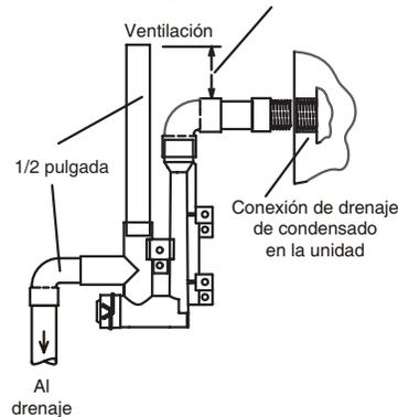
Conjunto de la trampa de drenaje con tubería de 3/4 de pulgada
