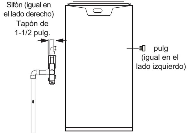
**NOTA:** En aplicaciones de flujo ascendente donde el filtro de aire de retorno lateral está instalado en el mismo lado que el sifón de condensado, el bastidor del filtro debe instalarse más allá del sifón de condensado o este debe reubicarse para evitar interferencias.
