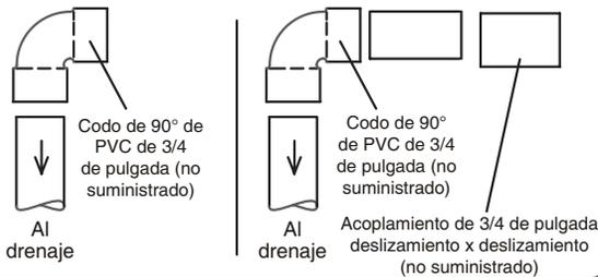
Conjunto de la trampa de drenaje con tubería de 1/2 pulgada
