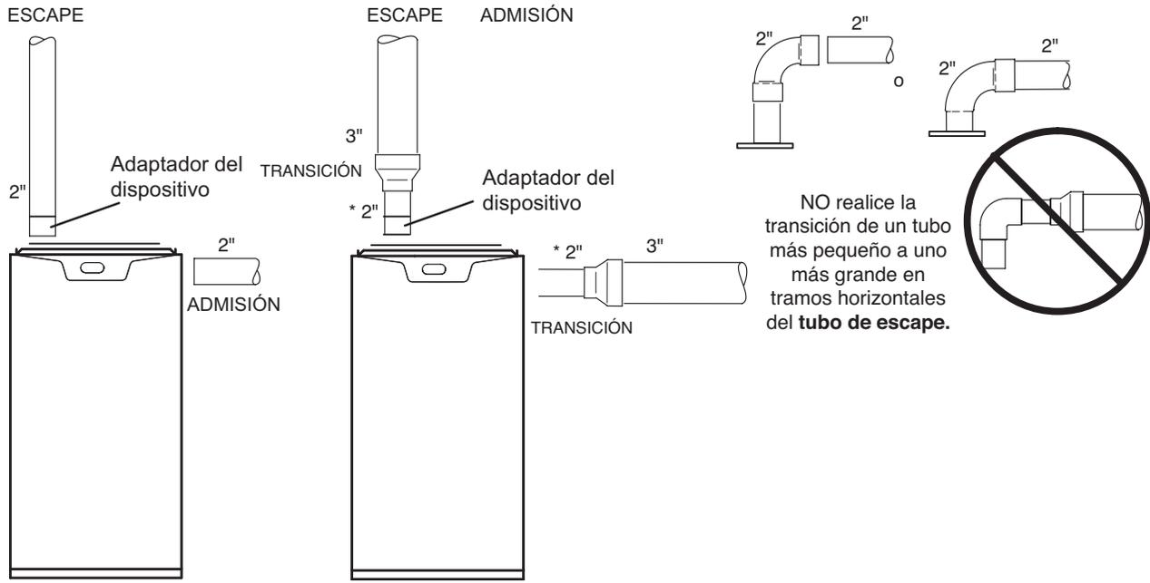
\* Al hacer la transición en el tamaño de la tubería, use la longitud más corta posible de tubería de PVC de 2".
