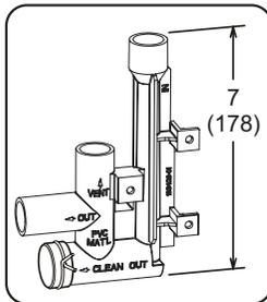
1 (25 mm) mín. 2 (50 mm) máx. sobre el extr. sup. de la conexión del drenaje de condensado en la unidad
