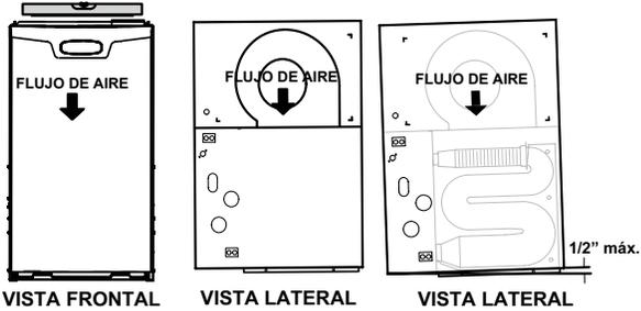
La unidad se debe nivelar de lado a lado. La unidad puede posicionarse desde el nivel hasta 1/2" hacia el frente para ayudar con el drenaje.
