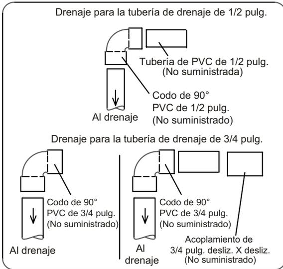
Ensamble de trampa de condensado con tubería de 1/2 pulg.
