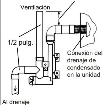
Ensamble de trampa de condensado con tubería de 3/4 pulg.
