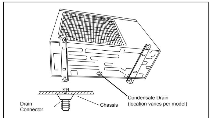
**Figure 20. Condensate Drain**
