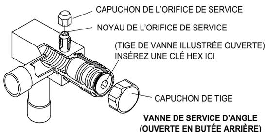
Lorsque la vanne de service est OUVERTE, l'orifice de service est ouvert sur le jeu de conduites, unité intérieure et extérieure.
