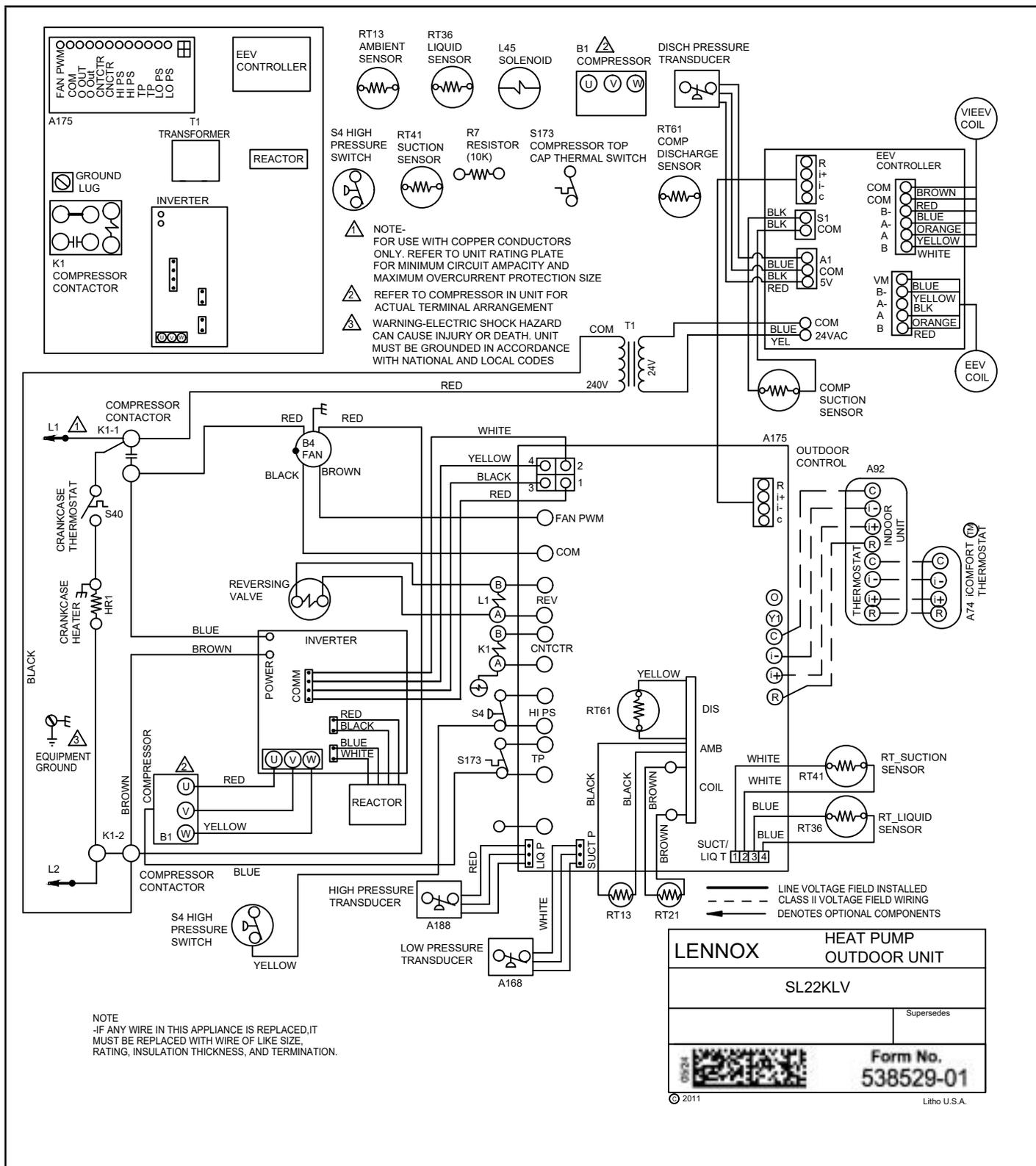
FIGURE 10. Câblage sur place typique
