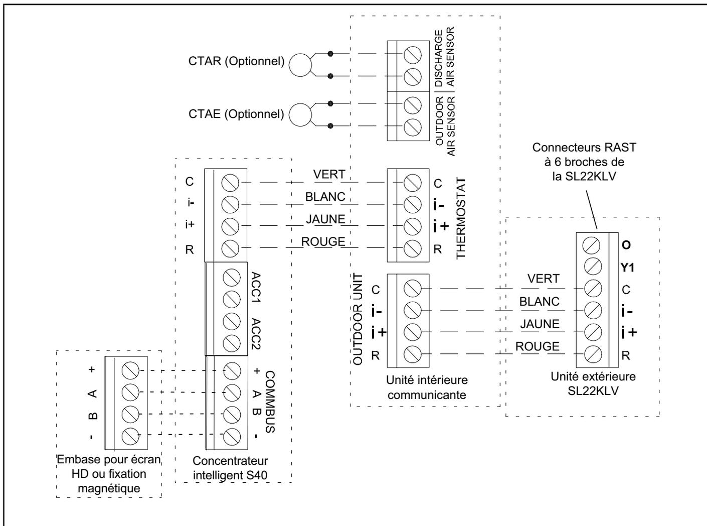
FIGURE 14. SL22KLV avec thermostat communicant S40 - Schéma de câblage sur place
