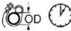
SUR LES CONDUITES DE 3/4 PO ET PLUS, INSTALLEZ LE BULBE DE DÉTECTION EN POSITION 3 OU 9 HEURES.
