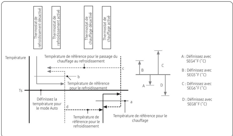
Le changement de mode entre les modes Cool (Frais) et Heat (Chauffage) s'effectue uniquement lorsque le thermo est désactivé pendant la durée définie avec SEG9.
