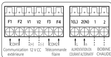
\* La sortie du terminal de la bobine chaude est de 220 V CA / 230 V (identique à la puissance d'entrée de l'unité intérieure)
