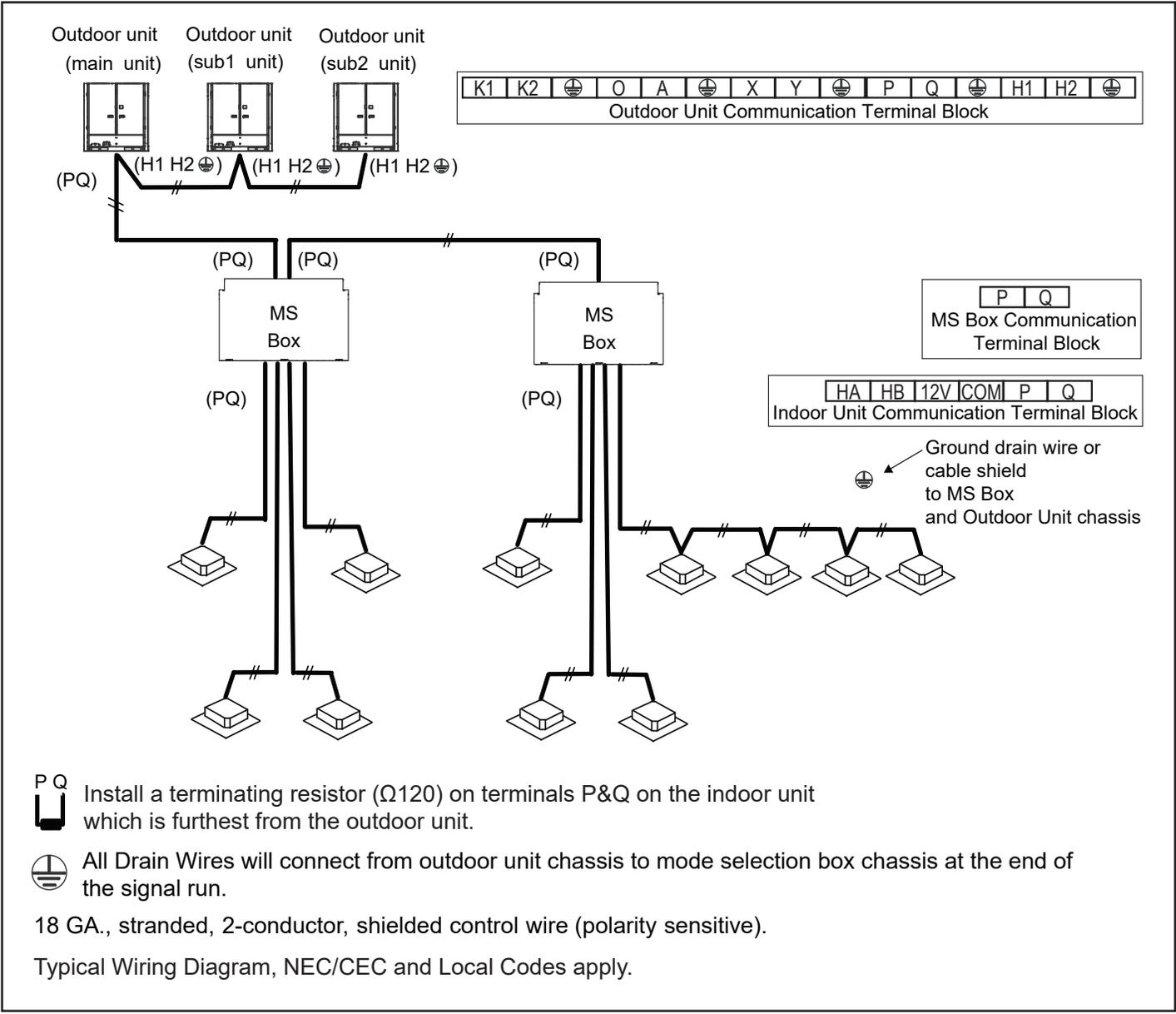
Figure 17. VRF System Communication Wiring Diagram
