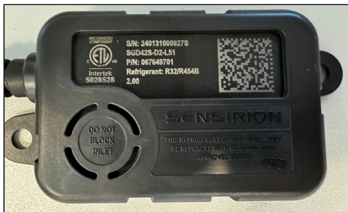
Figura 20. Ejemplo de entrada del sensor libre y sin obstrucciones
