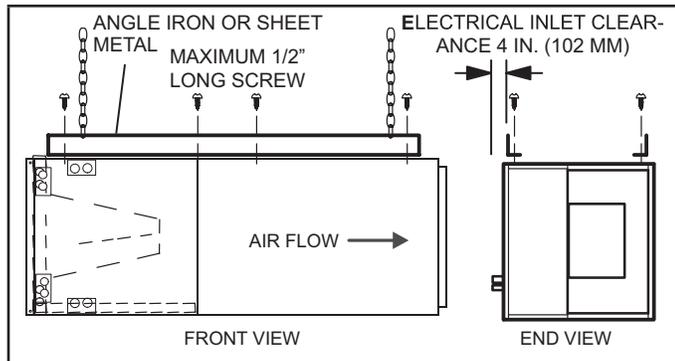
**FIGURE 14. Suspend Horizontal Unit**
