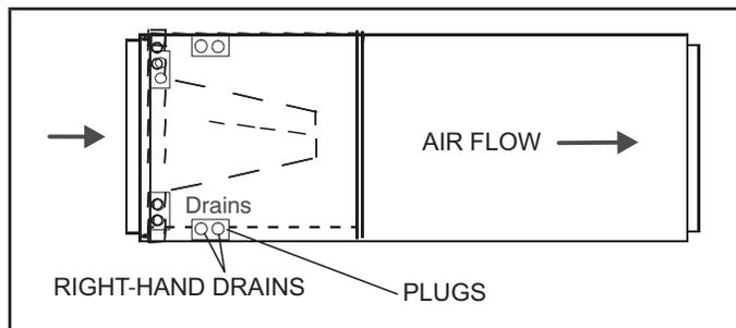
**FIGURE 17. Right-Hand Discharge Configuration**
