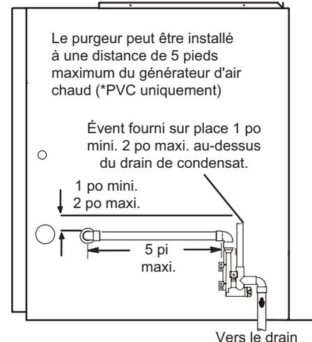
\*Le tuyau sortant de l'appareil doit avoir une pente minimum de 1/4 po par pied vers le purgeur
