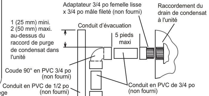
Conduit de drainage optionnel depuis le piège
