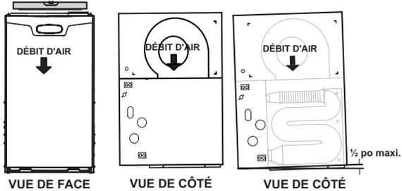
L'unité doit être de niveau transversalement. L'unité peut être positionnée de niveau à 1/2 po vers l'avant pour faciliter le drainage.
