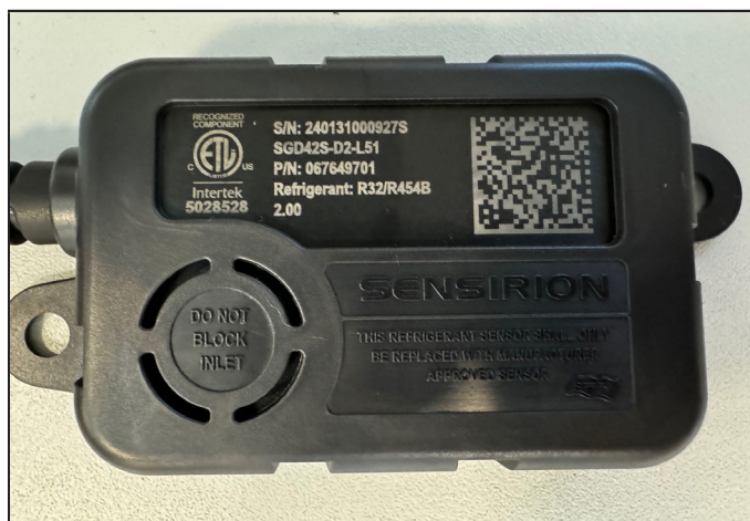
FIGURA 14. Ejemplo de entrada del sensor libre y sin obstrucciones
