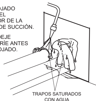
FIGURA 7. Soldadura de las líneas de refrigerante CONEXIÓN DE LA LÍNEA DE SUCCIÓN
