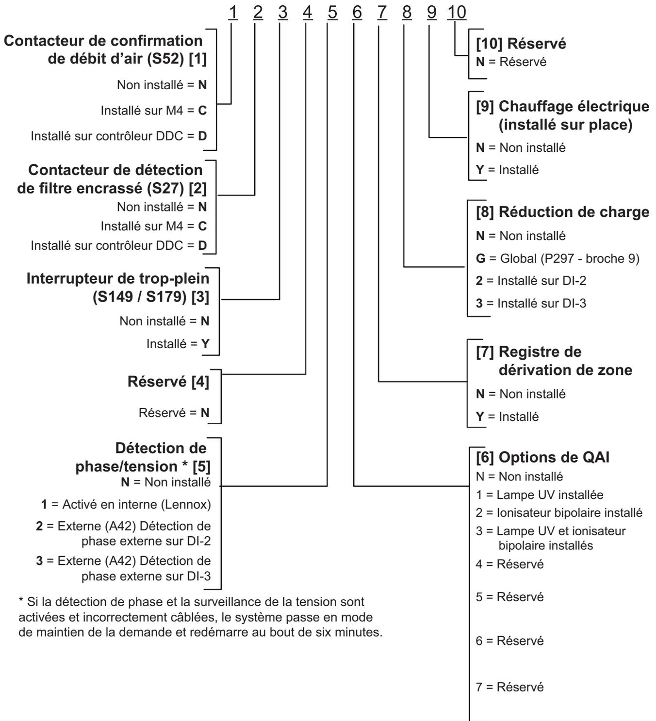
\* Si la détection de phase et la surveillance de la tension sont activées et incorrectement câblées, le système passe en mode de maintien de la demande et redémarre au bout de six minutes.
