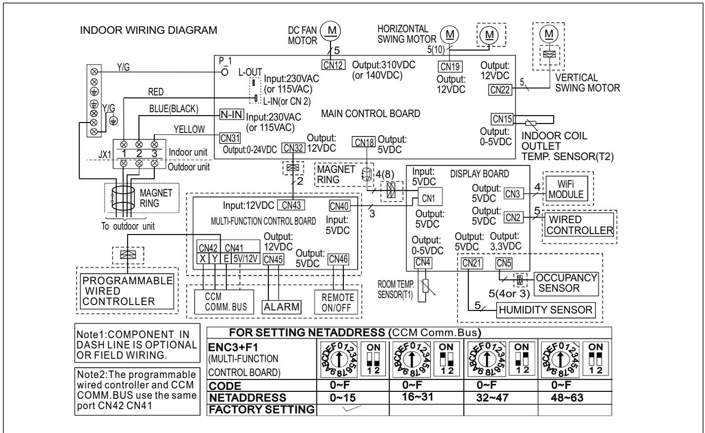
Figure 34. Schéma de câblage des unités MWMC
