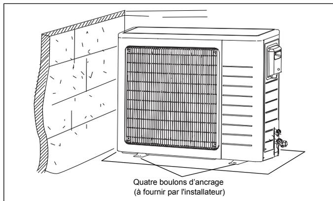
Figure 27. Fixation de l'unité extérieure sur une dalle
