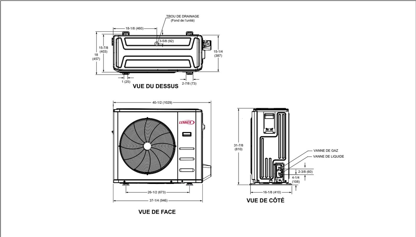
Figure 4. MPC024S4S - Dimensions de l'unité extérieure - pouces (mm)
