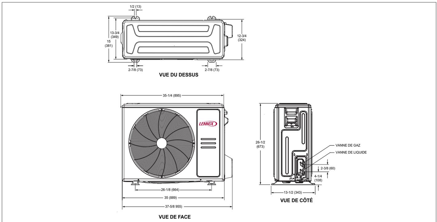
Figure 6. MLB018S4S - Dimensions de l'unité extérieure - pouces (mm)
