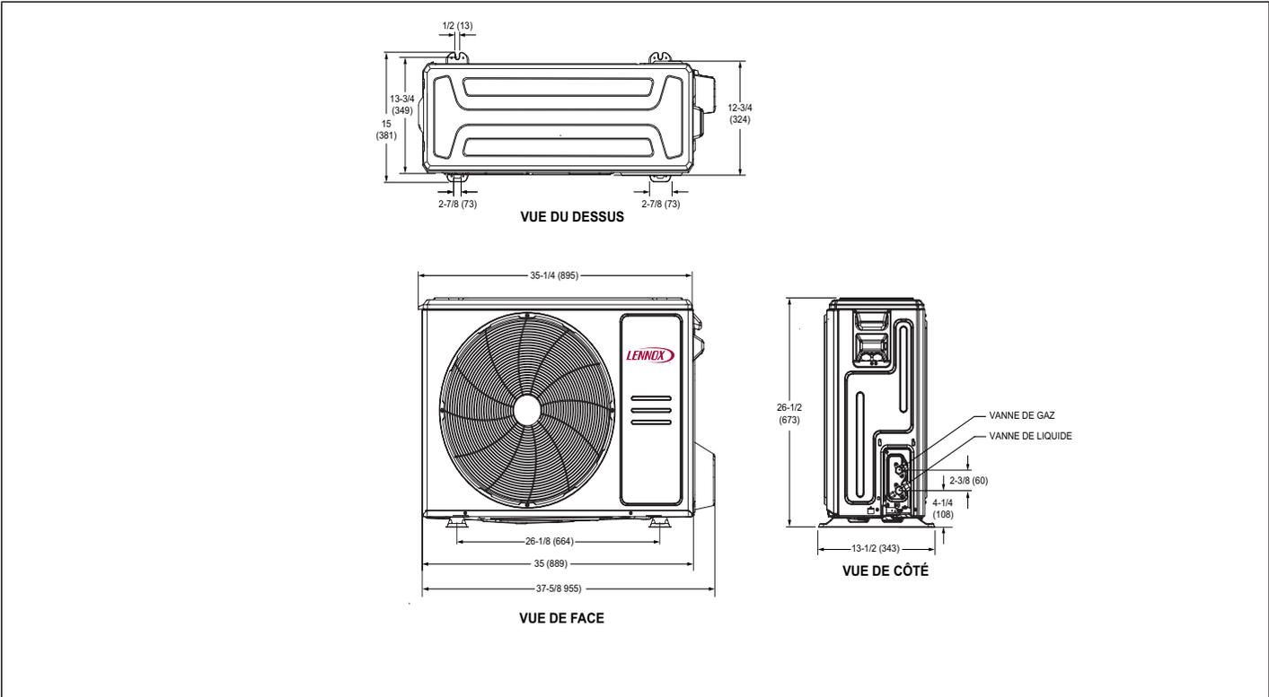
Figure 3. MPC018S4S - Dimensions de l'unité extérieure - pouces (mm)
