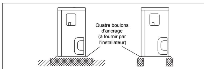
Figure 28. Fixation de l'unité extérieure sur des rails
