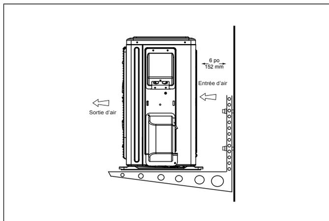
Figure 29. Fixation de l'unité extérieure sur des équerres
