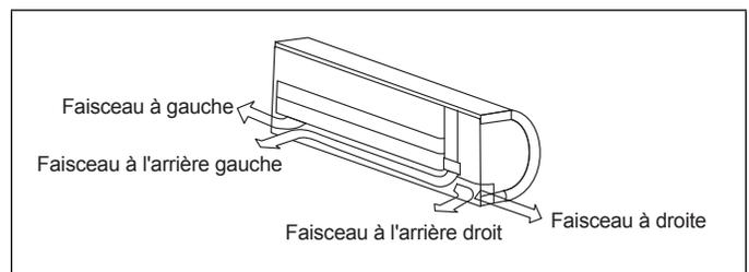
Figure 13. Détermination de la sortie du faisceau
