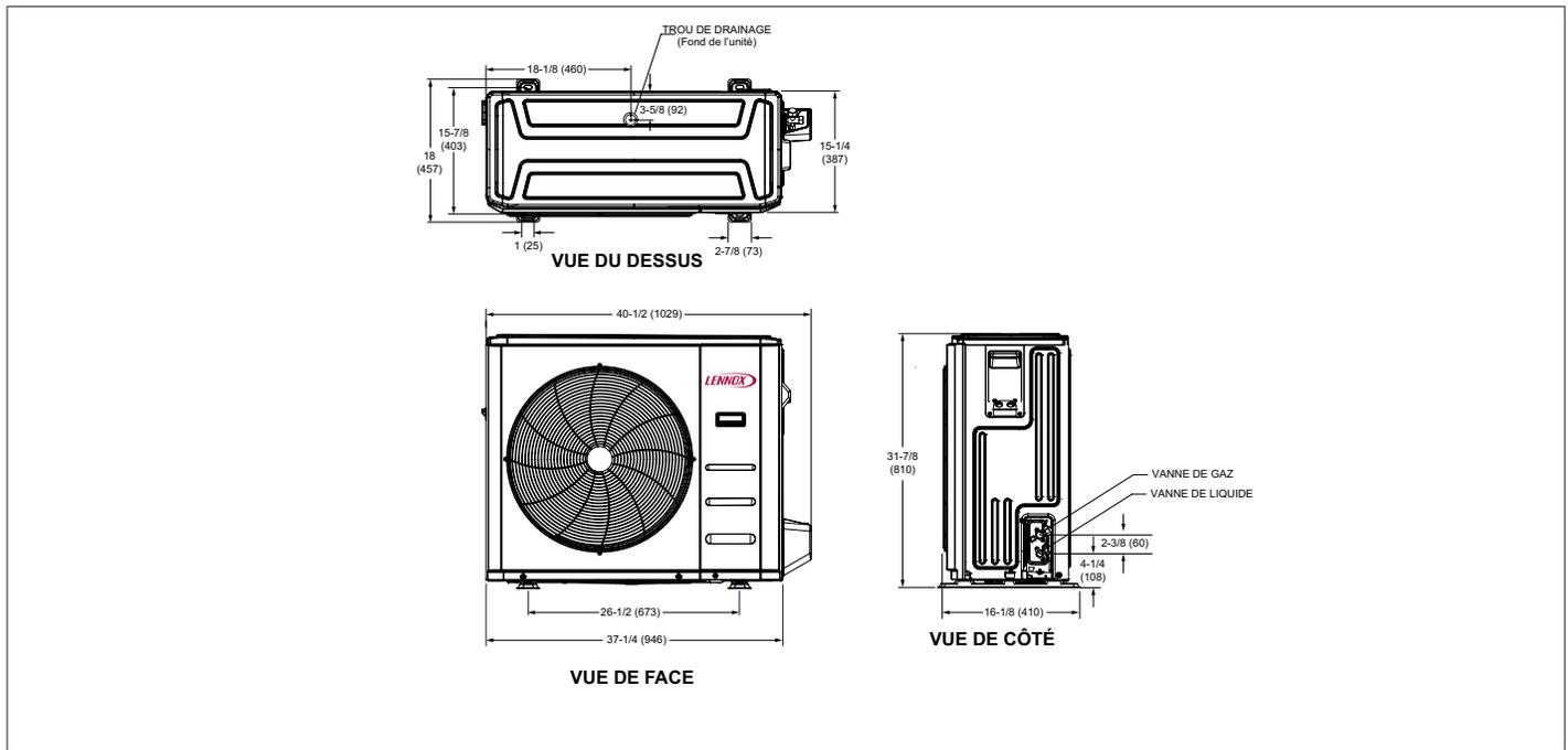
Figure 7. MLB024S4S - Dimensions de l'unité extérieure - pouces (mm)
