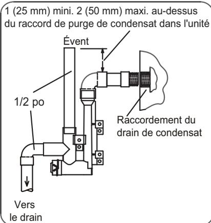
Ensemble drain/piège avec tuyau de 3/4 po
