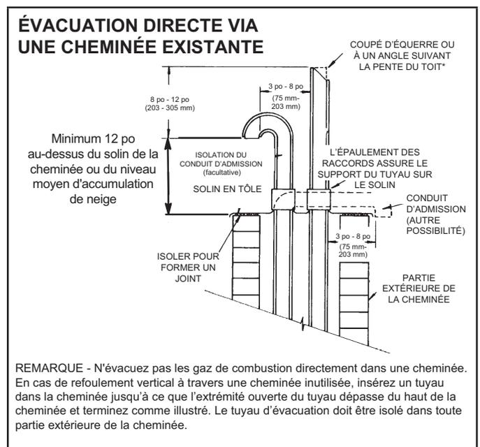
REMARQUE - N'évacuez pas les gaz de combustion directement dans une cheminée. En cas de refoulement vertical à travers une cheminée inutilisée, insérez un tuyau dans la cheminée jusqu'à ce que l'extrémité ouverte du tuyau dépasse du haut de la cheminée et terminez comme illustré. Le tuyau d'évacuation doit être isolé dans toute partie extérieure de la cheminée.
