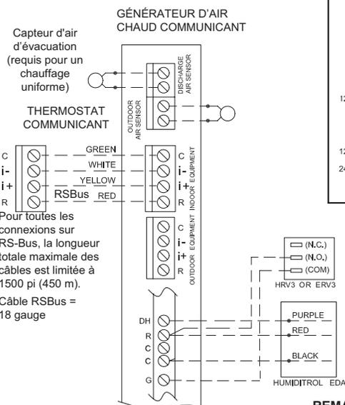
Pour toutes les connexions sur RS-Bus, la longueur totale maximale des câbles est limitée à 1500 pi (450 m).
