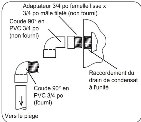
1 (25 mm) mini. 2 (50 mm) maxi. au-dessus du raccord de purge de condensat dans l'unité
