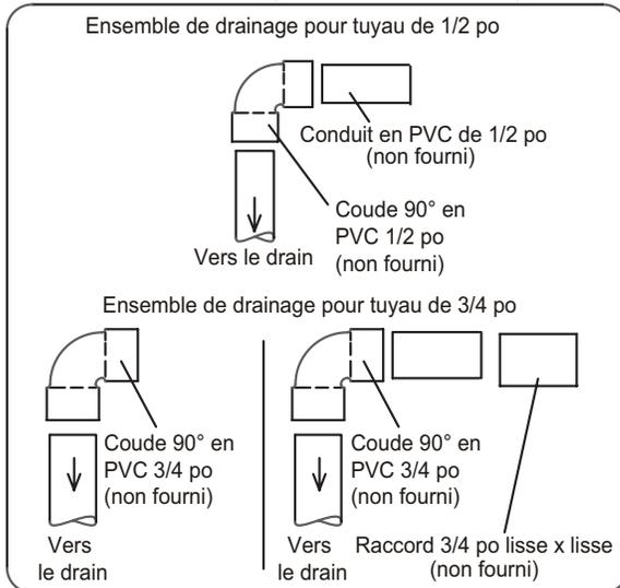
Ensemble drain/piège avec tuyau de 1/2 po
