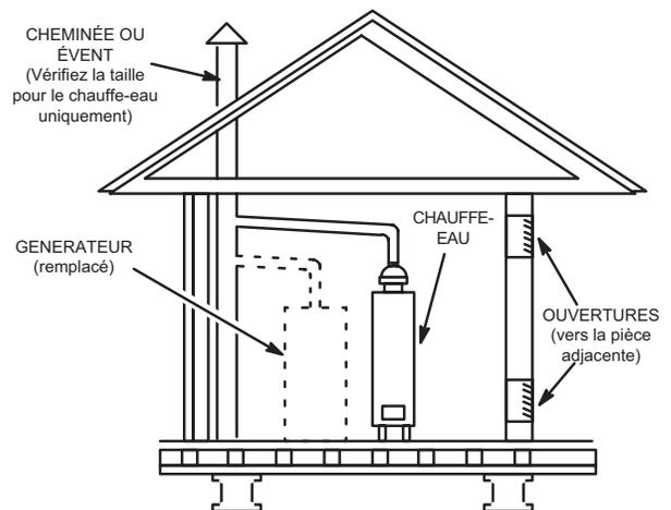
Si le générateur d'air chaud remplace un appareil qui partageait le conduit d'évacuation avec un autre appareil au gaz, il faut vérifier le diamètre du conduit. Sans la chaleur générée par les gaz d'évacuation de l'appareil de chauffage d'origine, le conduit d'évacuation existant est probablement surdimensionné pour la capacité du chauffe-eau ou de l'autre appareil seul. Le tirage du conduit d'évacuation doit être contrôlé avec l'appareil restant.
