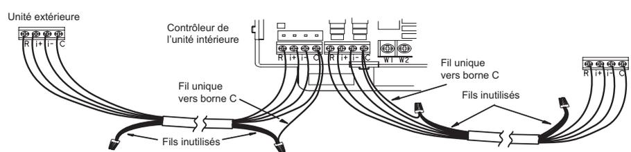
Les systèmes communicants utilisant un thermostat communicant nécessitent quatre fils de thermostat entre le thermostat et le contrôleur du générateur d'air chaud/ventilo-convecteur, et quatre fils entre l'unité extérieure et le contrôleur du générateur d'air chaud/ventilo-convecteur. Si un câble de thermostat avec plus de quatre fils est utilisé, les fils supplémentaires doivent être correctement connectés pour éviter tout bruit électrique. Les fils ne doivent pas être laissés déconnectés.
