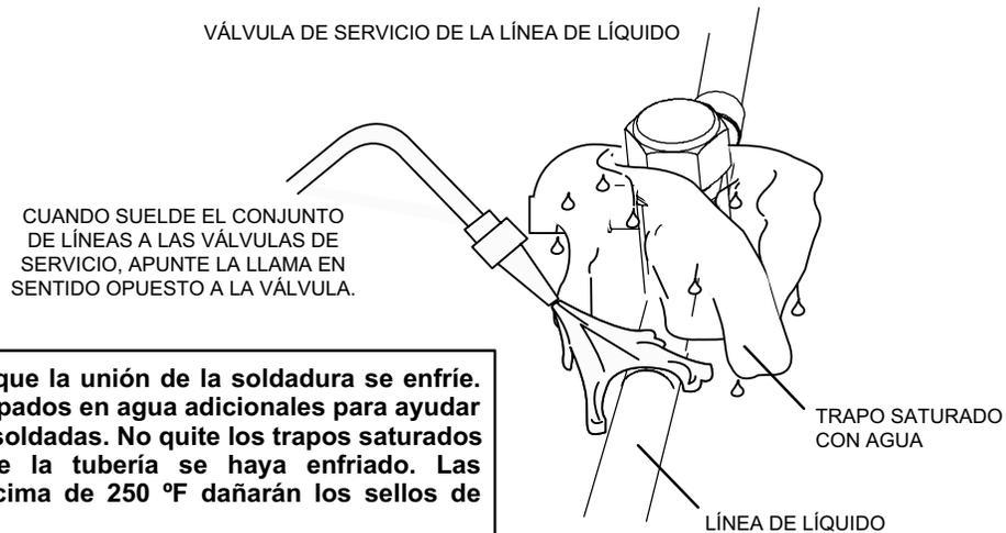
**¡IMPORTANTE!** Deje que la unión de la soldadura se enfríe. Coloque trapos empapados en agua adicionales para ayudar a enfriar las uniones soldadas. No quite los trapos saturados con agua hasta que la tubería se haya enfriado. Las temperaturas por encima de 250 °F dañarán los sellos de las válvulas.
