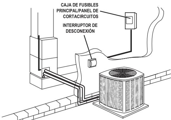
**NOTA:** Las unidades se aprueban para usarse con conductores de cobre únicamente. Conecte a tierra la unidad en el interruptor de desconexión o conéctela a una tierra sólida.
