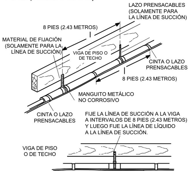
**NOTA** Se deben aplicar prácticas de instalación similares si el conjunto de líneas se instalará afuera de la pared exterior.
