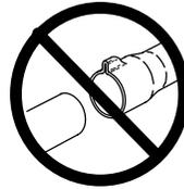
NO PLIEGUE EL CONECTOR DE LA VÁLVULA DE SERVICIO SI LA TUBERÍA ES MÁS PEQUEÑA QUE LA CONEXIÓN
