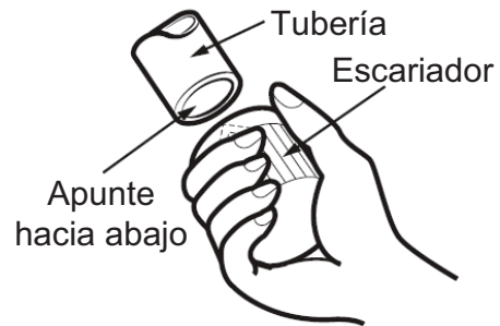
Figura 7. Posicionamiento adecuado del escariador
