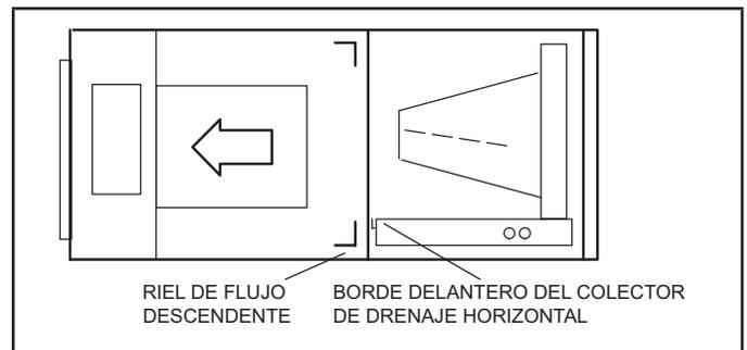
**FIGURA 12. Configuración de descarga a la izquierda**
