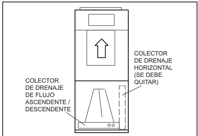
FIGURA 8. Configuración de flujo ascendente APLICACIONES HORIZONTALES
