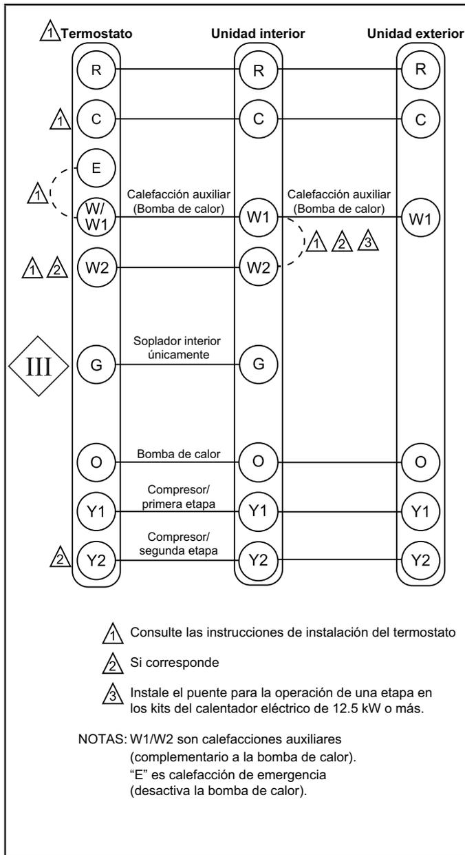
**FIGURA 2. Designaciones del termostato – Sin comunicación**
