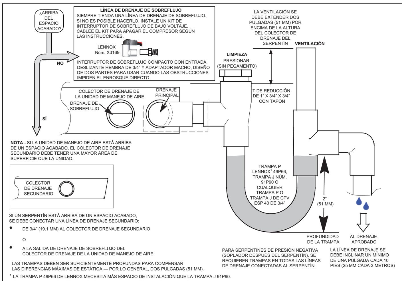
FIGURA 13. Drenaje típico principal y de sobreflujo
