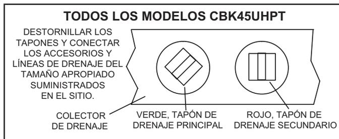
FIGURA 15. Conexiones de las líneas de drenaje
