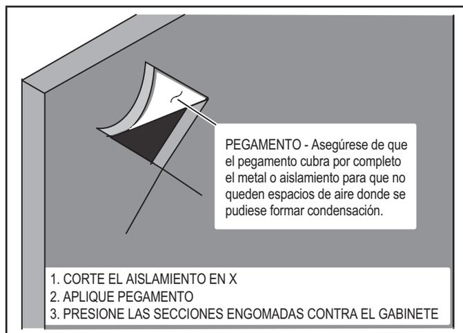
FIGURA 18. Reparación del aislamiento
