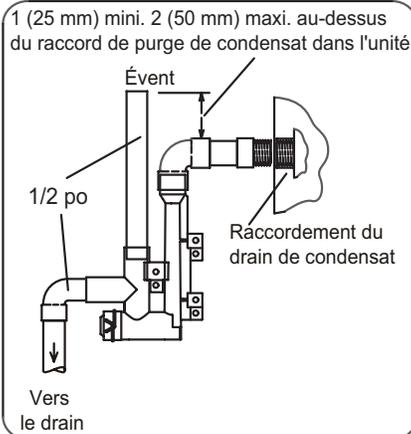
Ensemble drain/piège avec tuyau de 3/4 po
