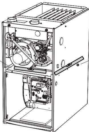
Placer le niveau sur les vis de la plate-forme du ventilateur pour vérifier l'inclinaison vers l'avant
