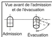
1 - La terminaison d'évacuation en T doit être connectée au conduit d'évacuation en PVC de 2 po ou 3 po comme indiqué sur l'illustration. Sur les applications à T horizontal, il doit y avoir un minimum de 3 pi des patios couverts ou de toute zone habitée et ne peut pas être à moins de 3 pi d'une fenêtre. Ne pas utiliser d'accélérateur dans les applications qui incluent une terminaison d'évacuation en T. L'accélérateur n'est pas obligatoire.
