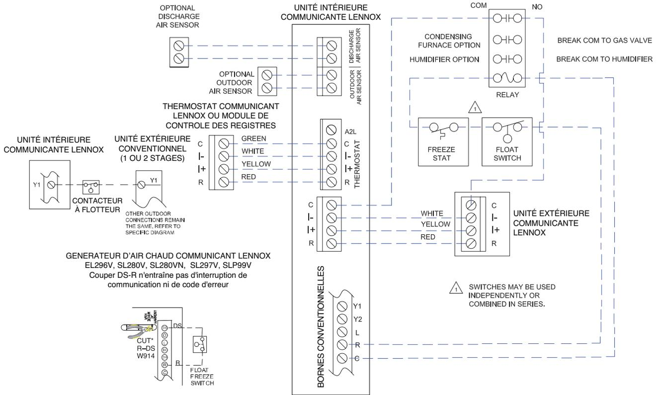
Réglage des microcontacts et câblage sur place
