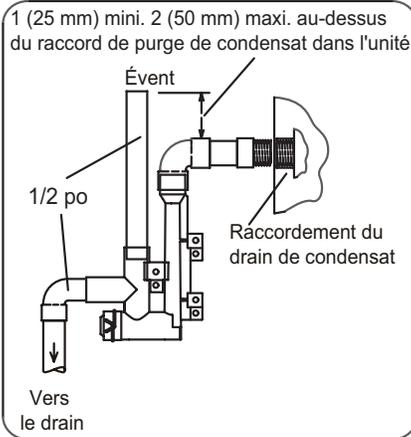
Ensemble drain/piège avec tuyau de 3/4 po
