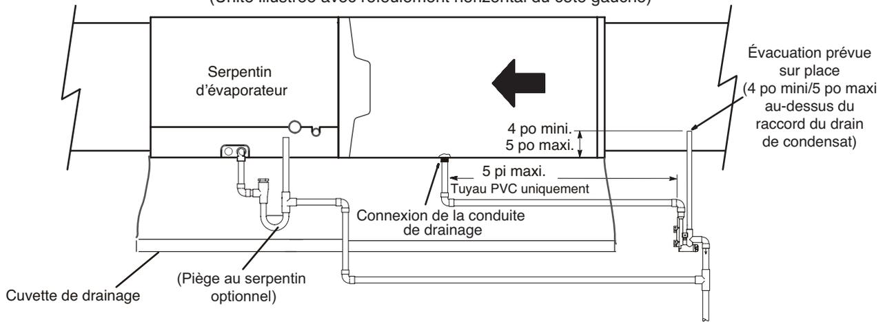
Le tuyau provenant de l'appareil et du serpentin de l'évaporateur doit avoir une pente minimum de 1/4 po par pied vers le purgeur
