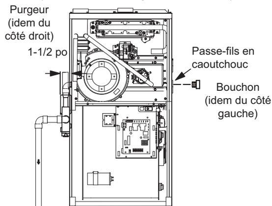
**REMARQUE** - Dans les configurations ascendantes dans lesquelles un filtre de retour d'air latéral est installé du même côté que le purgeur de condensat, le support du filtre doit être installé au-delà du purgeur pour éviter toute interférence. Une autre solution consiste à déplacer le purgeur.
