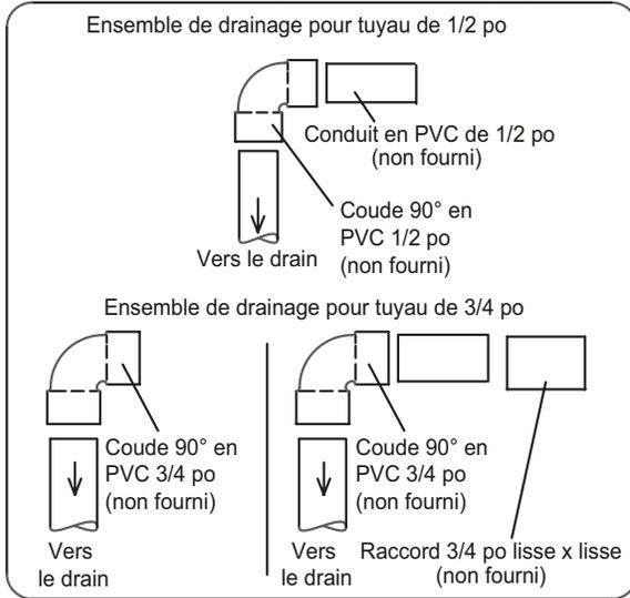
Ensemble drain/piège avec tuyau de 1/2 po
