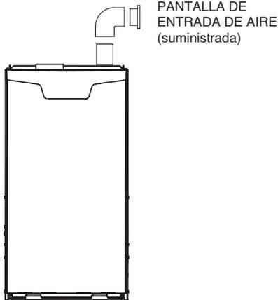
**NOTA:** La pantalla de entrada de aire y el codo se pueden girar, de modo que la pantalla se pueda posicionar apuntando hacia adelante o a cualquier lado.
