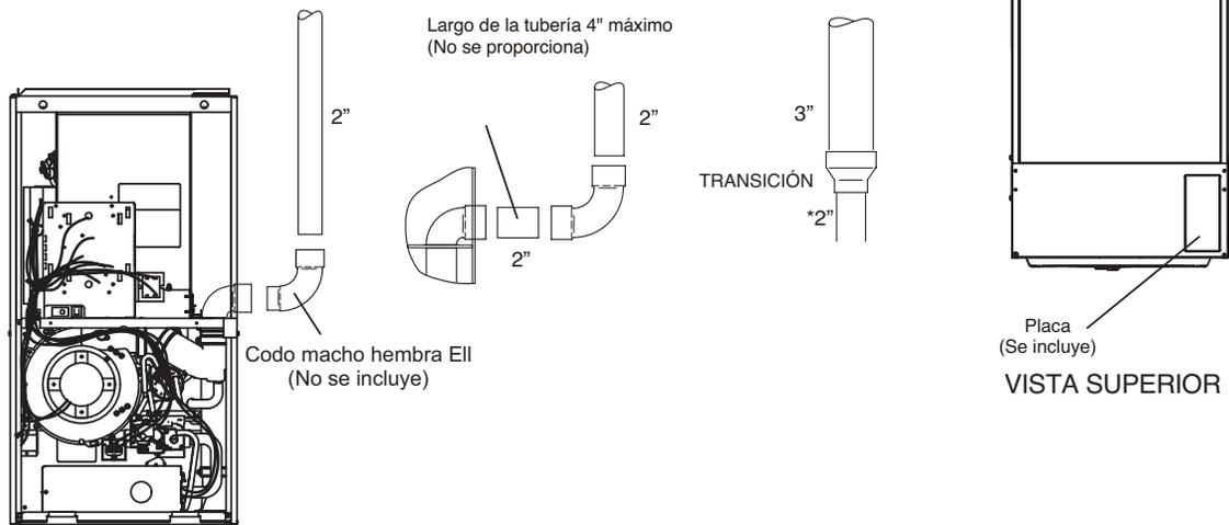
\* Durante la transición de aumento de tamaño de la tubería, use la sección más corta posible de tubería de PVC de 2".
