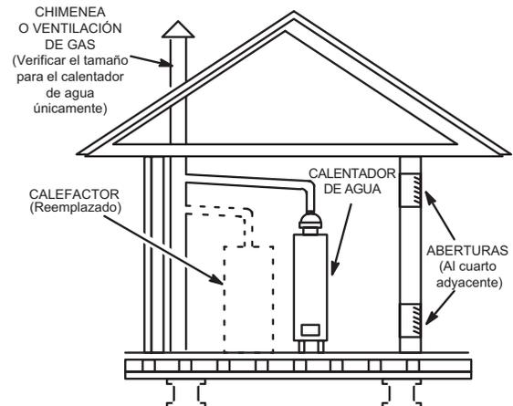
Si se reemplaza un calefactor que tenía una ventilación común con otro artefacto a gas, debe revisarse el tamaño de la tubería de ventilación existente para ese artefacto a gas. Sin el calor de los productos de la combustión del calefactor original, es probable que la tubería de ventilación existente esté sobredimensionada para el único calentador de agua u otro artefacto. La ventilación se debe revisar para verificar el consumo apropiado con el artefacto restante.
