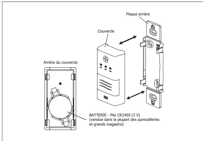
Figure 19. Remplacement de la pile
