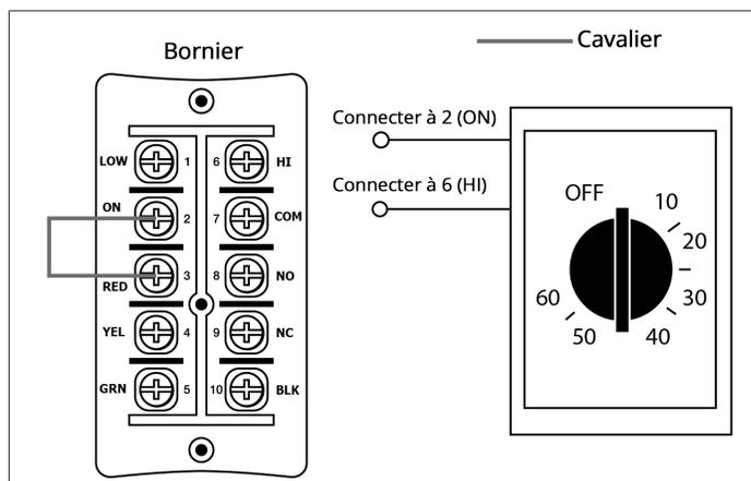
Figure 42. Installation d'une minuterie câblée (Configuration A)
