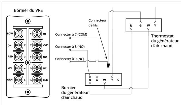
Figure 44. Configuration de verrouillage A
