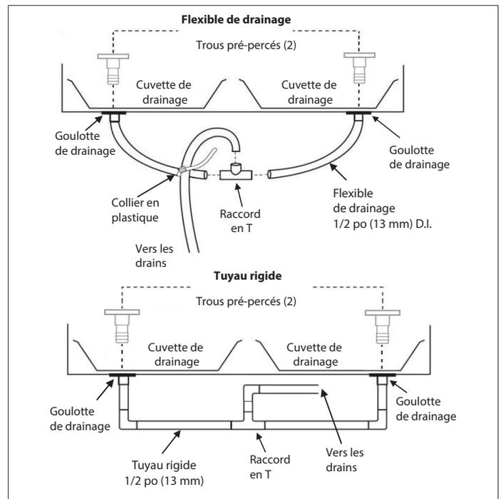
**Figure 31. Trous de drainage et siphon (VRE/VRC)**
