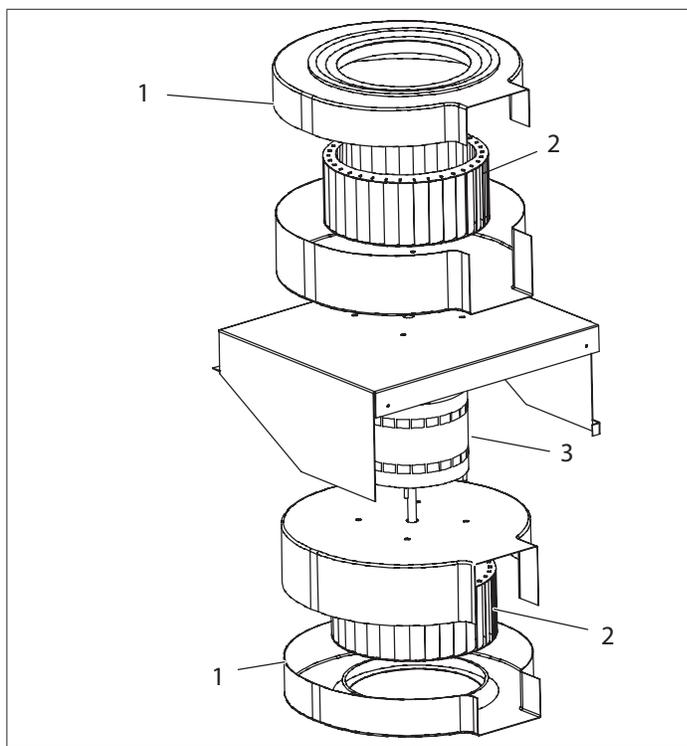
Figure 66. Remplacement du moteur
