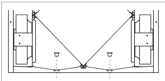
Figure 32. Installation des obturateurs
