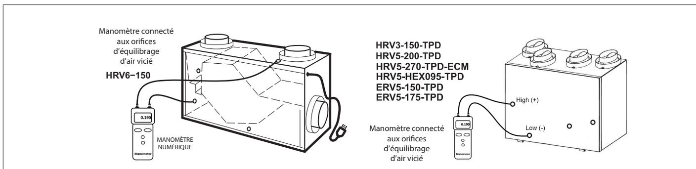
Figure 58. Orifices d'équilibrage - Air vicié
