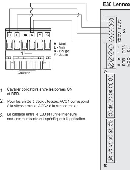
Figure 10. Câblage du E30 Lennox à l'équipement de ventilation
