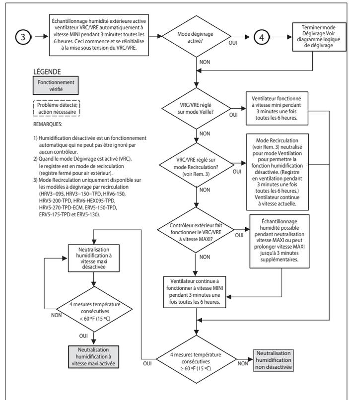
Figure 62. Déshumidistat désactivé
