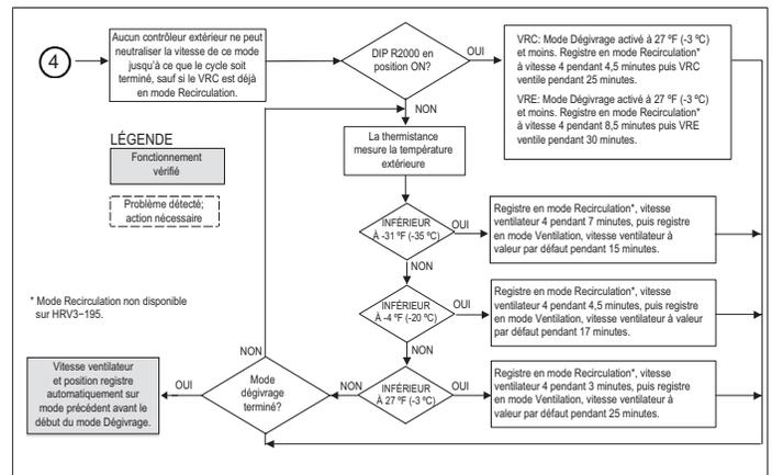
Figure 63. Mode de dégivrage du VRE/VRC
