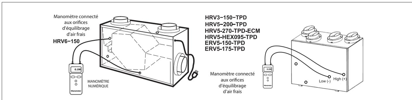
Figure 57. Orifices d'équilibrage - Air frais
