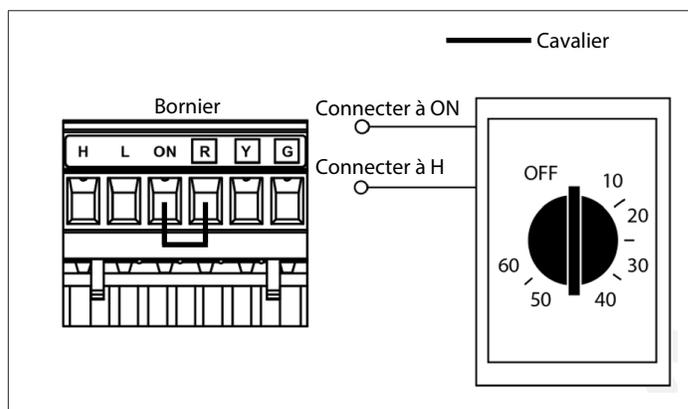
Figure 43. Installation d'une minuterie câblée (Configuration B)
