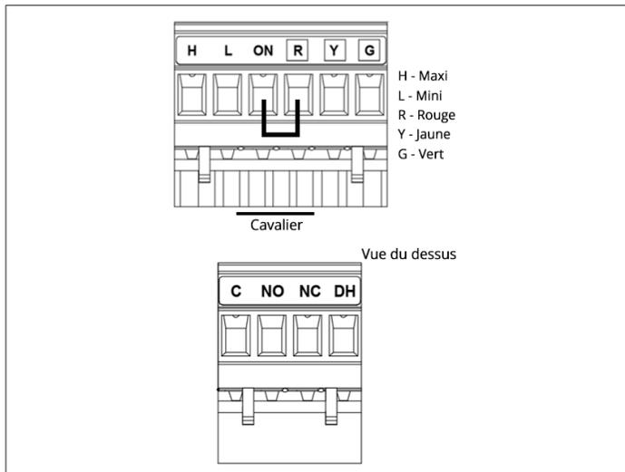
Figure 47. Bornier du VRE/VRC
