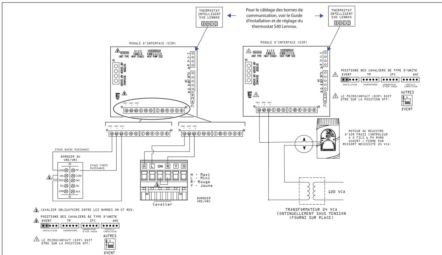
Figure 12. Thermostat intelligent S40 Lennox, Module d'interface et Ventilation (VRE/VRC ou Register d'air frais)
