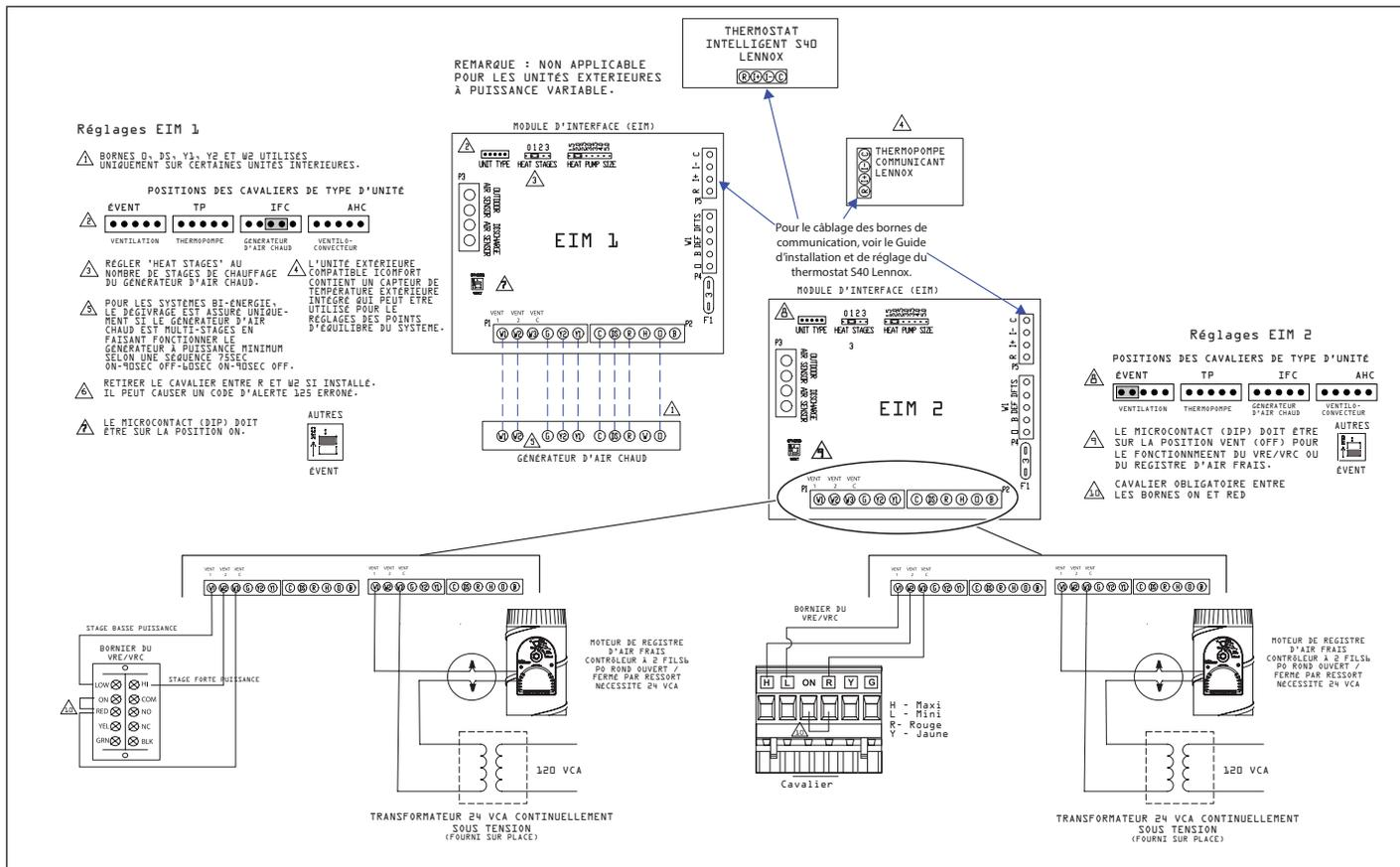
Figure 13. Thermostat intelligent S40 Lennox, Module d'interface, générateur d'air chaud non-communicant, thermopompe communicante et Ventilation (VRE/VRC ou Register d'air frais)
