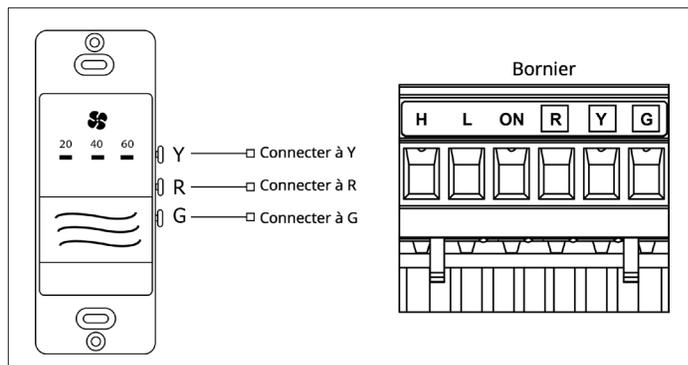
Figure 41. Installation d'une minuterie câblée (Configuration B)
