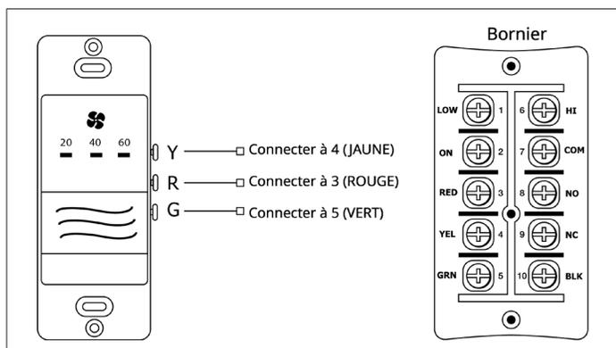
Figure 40. Installation d'une minuterie câblée (Configuration A)
