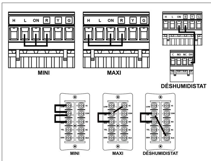
Figure 48. Addition de contrôleurs à contacts secs
