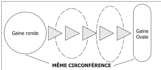
Figure 5. Formage des conduits pour les orifices ovales
