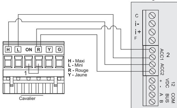
Utiliser 18-2 pour A B et du câble blindé à 2 conducteurs pour i+ i-
