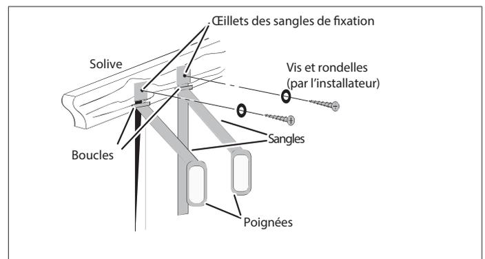
Figure 27. Insérer les vis et rondelles
