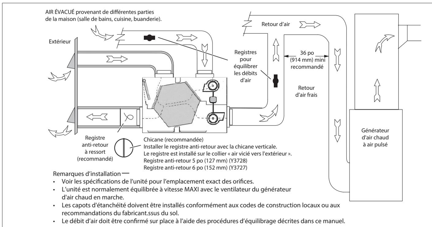
**Figure 24. Connexion directe de l'air d'alimentation au retour d'air froid du générateur d'air chaud (l'air vicié est aspiré des zones principales de la maison)**
