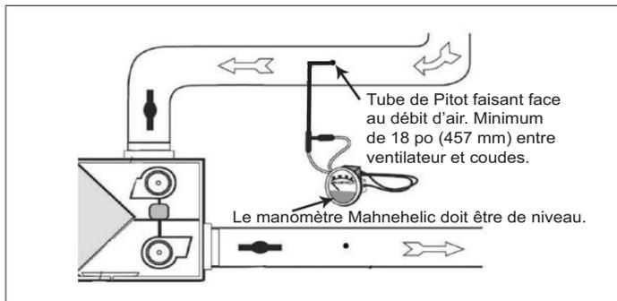
Figure 53. Insérer le tube de Pitot
