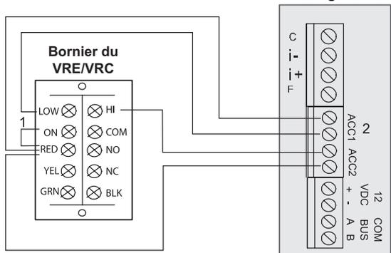
Utiliser 18-2 pour A B et du câble blindé à 2 conducteurs pour i+ i-
