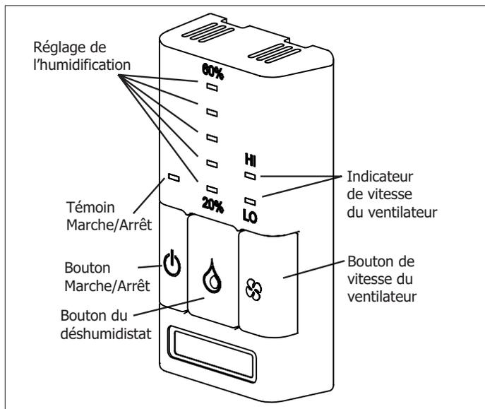
Figure 15. Contrôleur à bouton-poussoir H/C VRE/VRC (Y8249)
