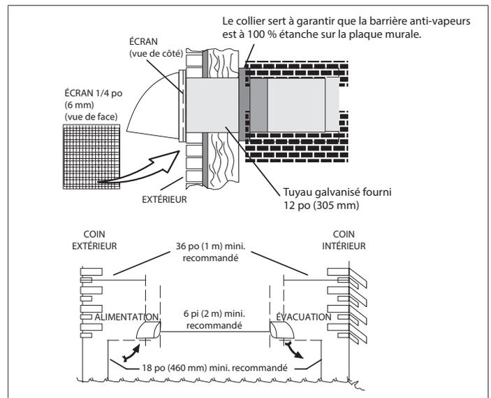
**Figure 34. Installation typique d'une hotte anti-intempéries**
