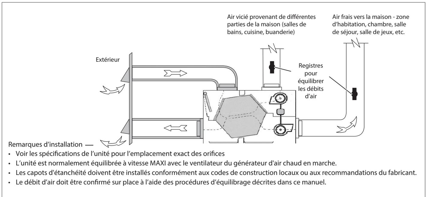
Figure 26. Système entièrement dédié (non connecté à un système à air pulsé)
