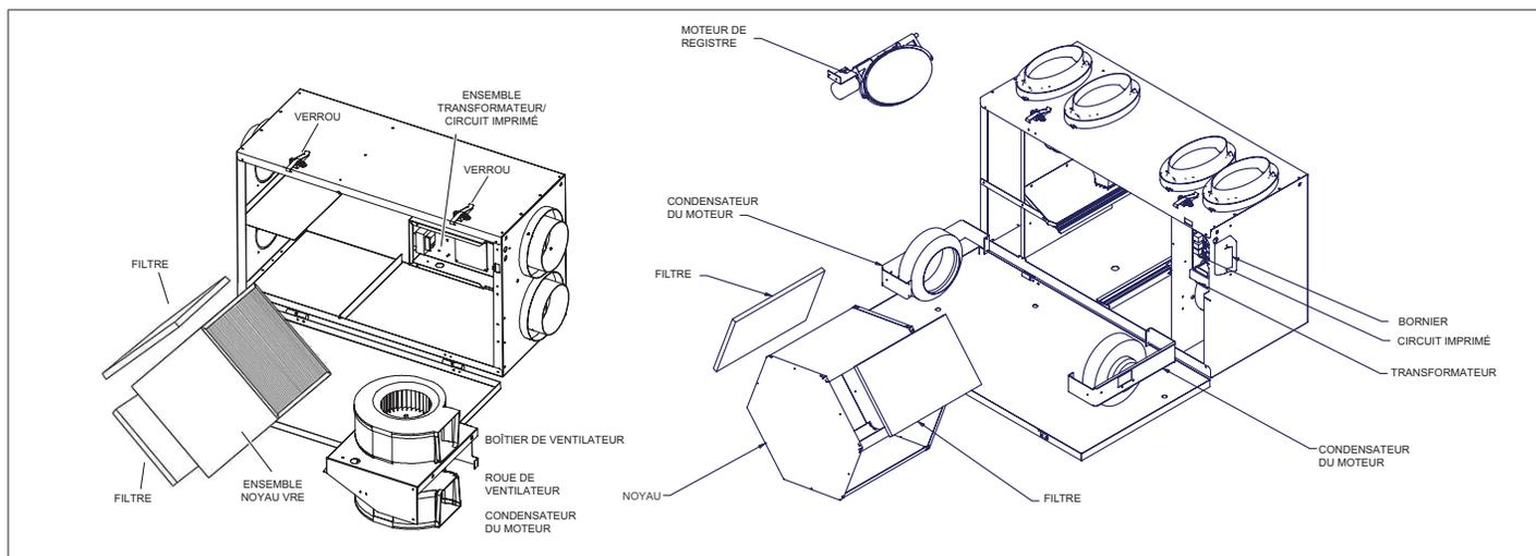
Figure 64. Emplacement des pièces
