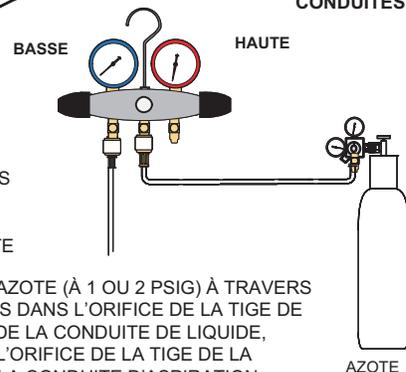
FAITES CIRCULER DE L'AZOTE (À 1 OU 2 PSIG) À TRAVERS LE JEU DE MANOMÈTRES DANS L'ORIFICE DE LA TIGE DE LA VANNE DE SERVICE DE LA CONDUITE DE LIQUIDE, POUR RESSORTIR PAR L'ORIFICE DE LA TIGE DE LA VANNE DE SERVICE DE LA CONDUITE D'ASPIRATION.
