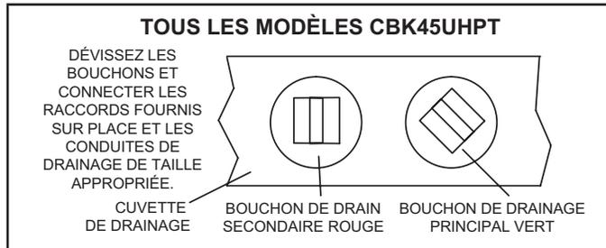
**FIGURE 15. Connexions des conduites de drainage**
