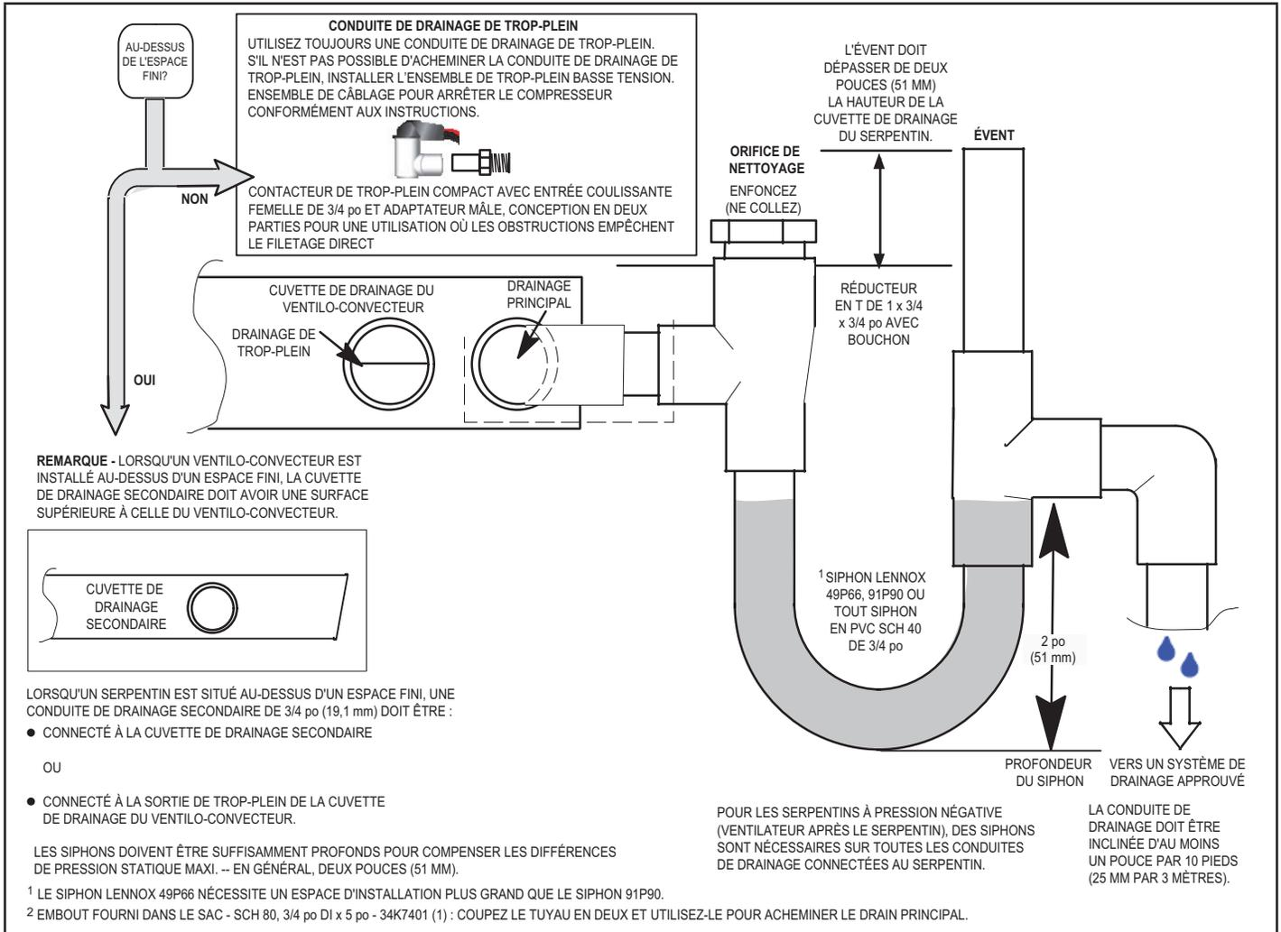
FIGURE 13. Drain principal et drain de trop-plein types
