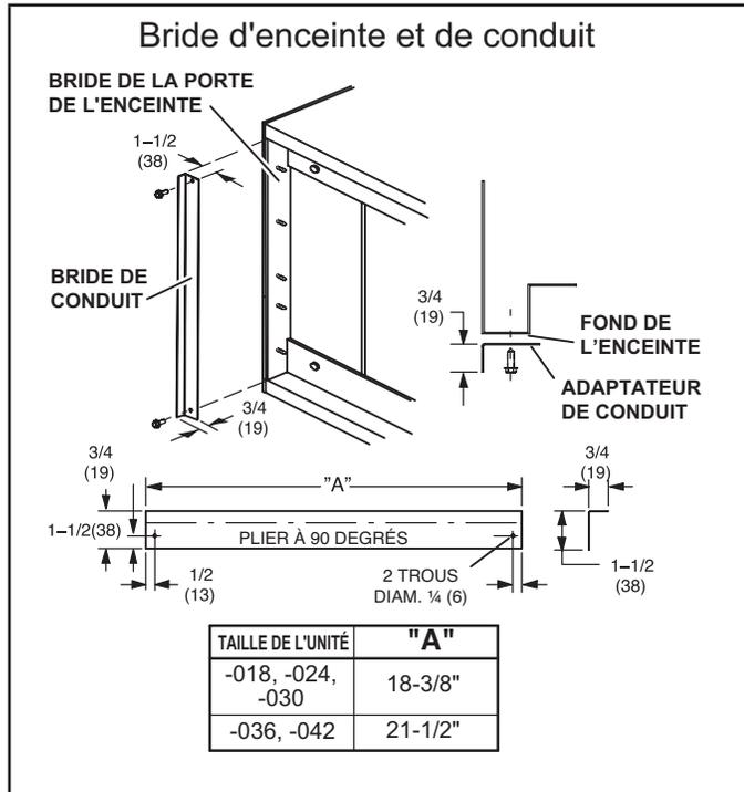
FIGURE 16. Bride d'enceinte et de conduit
