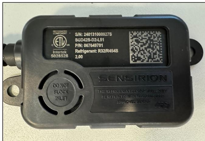
FIGURE 23. Exemple d'entrée de capteur dégagée et non bouchée
