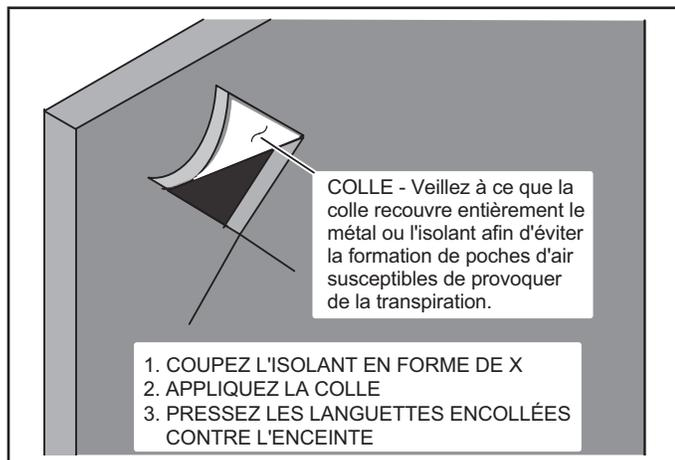
FIGURE 22. Réparation de l'isolation
