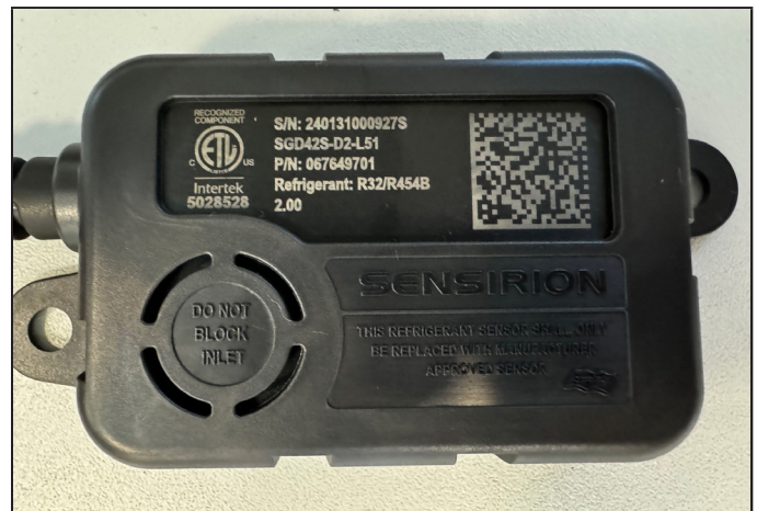
FIGURA 36. Ejemplo de entrada del sensor libre y sin obstrucciones
