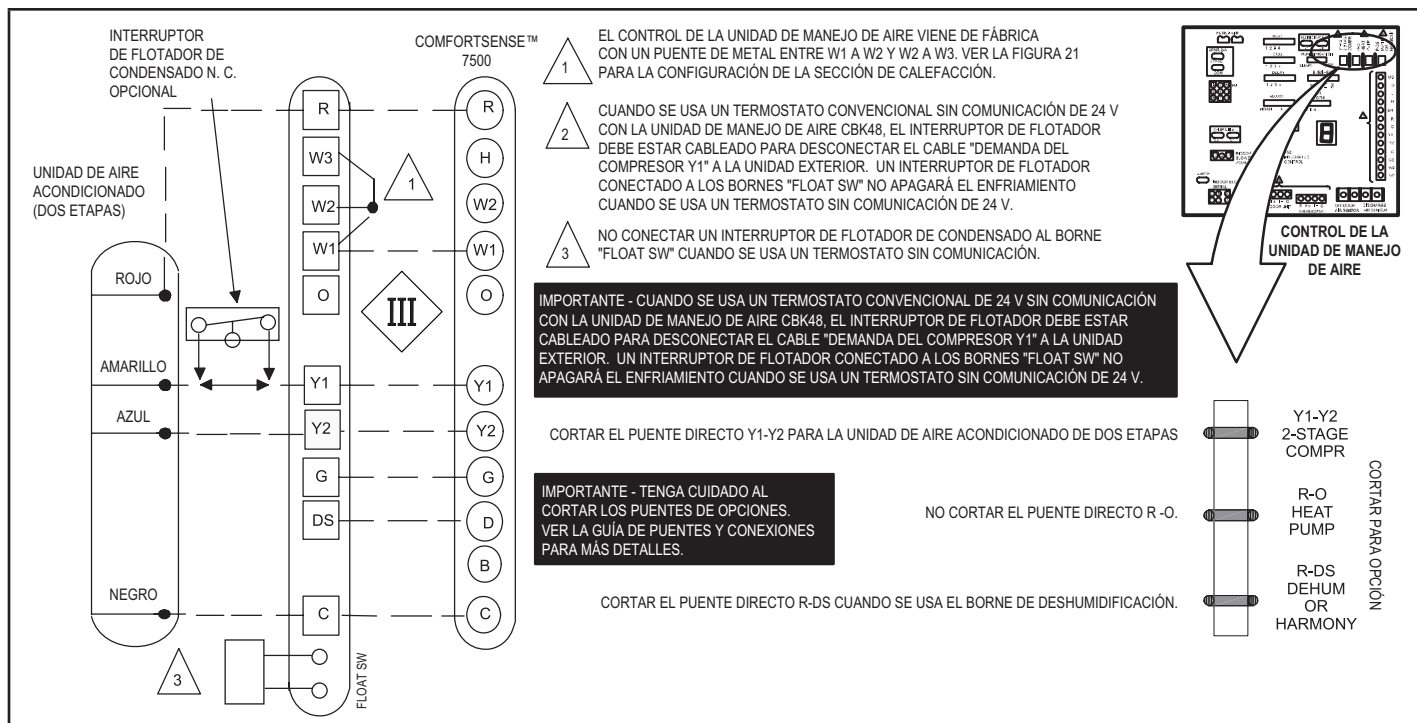
FIGURA 4. Control (cableado en el sitio): aplicación de enfriamiento (sin comunicación)
