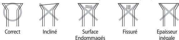
6. Aligner les tuyaux puis serrer les écrous évasés avec les mains, puis avec une clé dynamométrique en appliquant le couple qui suit.
